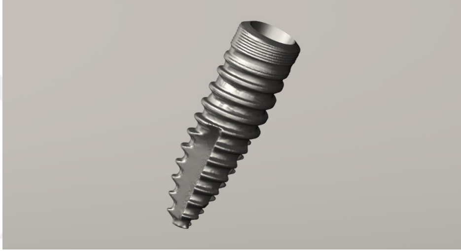
Şekil 10. SmartOptics 3 boyutlu tarayıcısıyla taranan Medentika Quattrocone standart implantın görüntüsü
