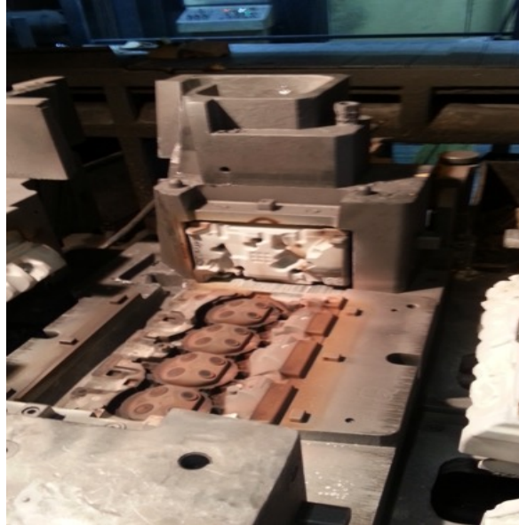
Şekil 3.1 Poteyaj işlemi yapılmış döküm kalıbı (Kişisel arşiv, 2015)
