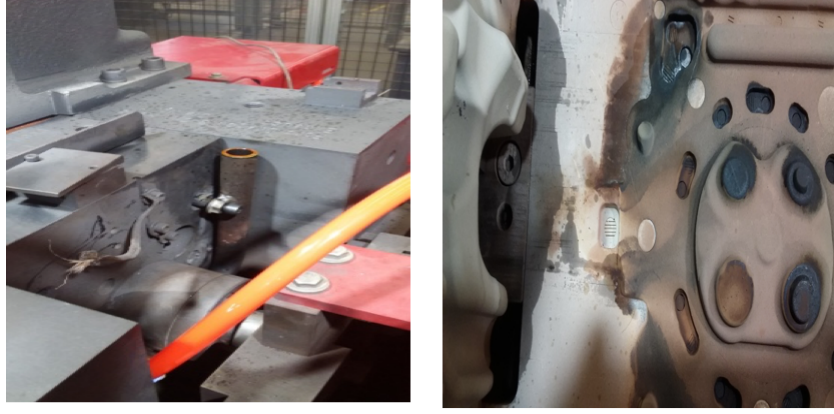
Şekil 2.6 (a) Çelik maçaaya vakum ilavesi ve (b) Maça başı bölgesindeki etkisi (Kişisel arşiv, 2015)
