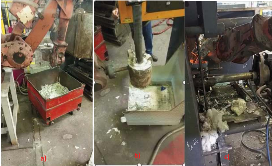
Şekil 3.7 Yarı katı metal hazırlama ünitesi ile YBD tezgahında GISS metodu dökümü a) bekletme ocağından sıvı metal transferi, b) asal gaz ile yarı katı metal hazırlama, c) yarı katı metalin kovana transferi
