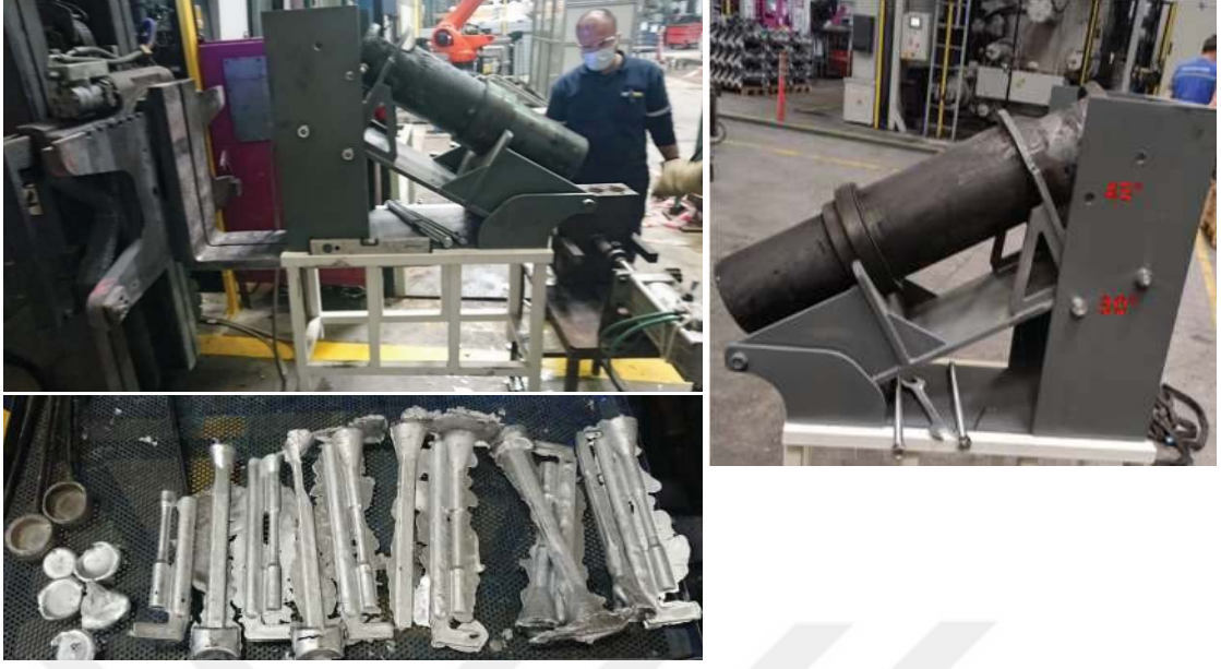
Şekil 3.2 Eğimli Soğutmalı Plaka ile yarı katı numune döküm düzeneği ve dökülen numuneler
