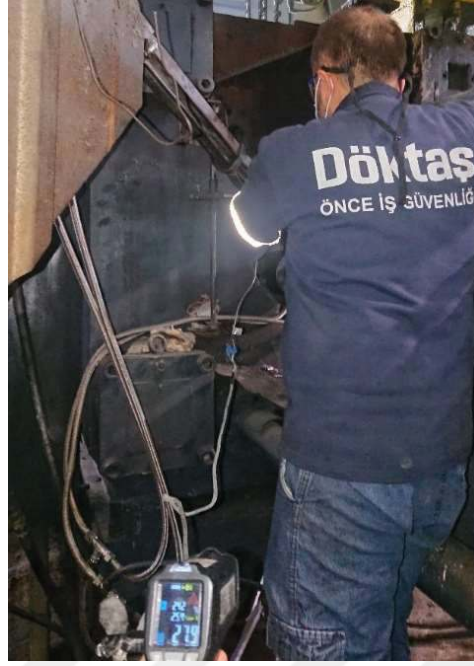
Şekil 3.4 Eğimli Soğutmalı Plaka YBD tezgahı döküm sırasındaki manuel sıcaklık kontrollerine ait görsel
