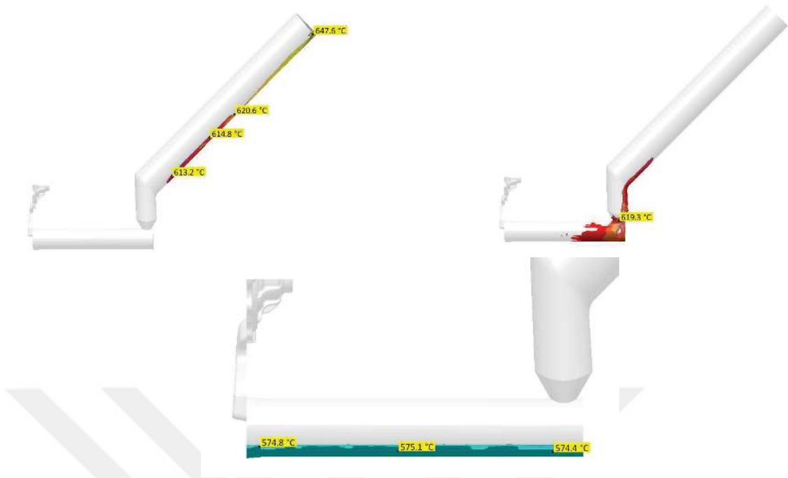
Şekil 3.25 Eğimli Soğutmalı Plaka Magmasoft Simülasyonları a)650°C sıvı metal verildiğinde plakadaki sıcaklık değişimi, b)Eğimli plakadan kovana sıvı metal boşaltılırken ki sıcaklık, c)Sıvı metalin kovanda 5sn beklemesi sonrasındaki sıcaklığı
