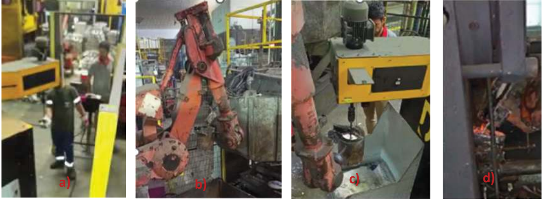
Şekil 3.10 Yarı katı metal hazırlama ünitesi ile YBD tezgahında entalpi çubuğu ile yarı katı parça dökümü a)entalpi çubuğu yükleme, b) sıvı metalin potaya aktarımı, c)entalpi çubuğu ile yarı katı metal hazırlama, d)yarı katı metalin kovana transferi
