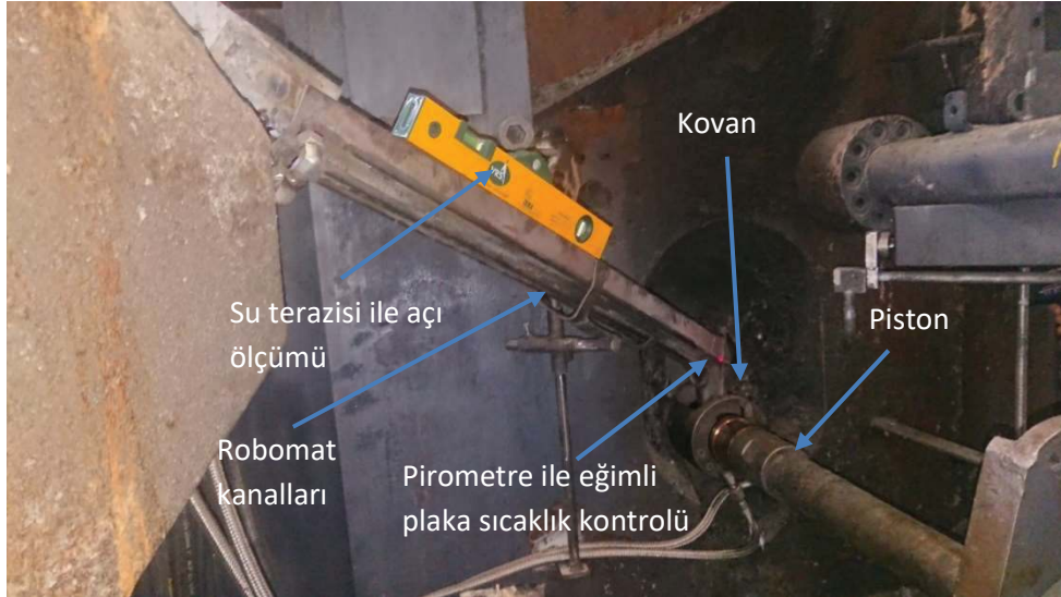
Şekil 3.3 Eğimli Soğutmalı Plaka YBD tezgahındaki görüntüsü
