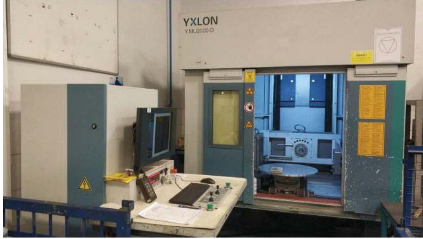
Şekil 3.24 YXLON MU2000 model X-ışını radyografi cihazı
