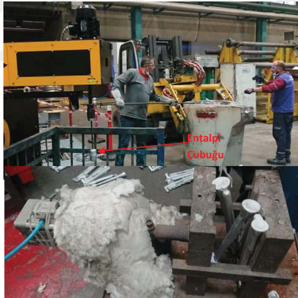
Şekil 3.9 Entalpi Çubuğu Yarı Katı Dökümü Numune Döküm Görseli
