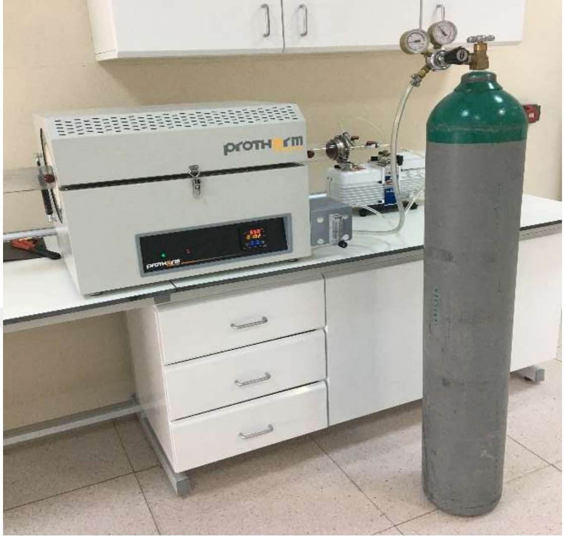
Şekil 3.3. Atmosfer kontrollü ısıl işlem fırını
