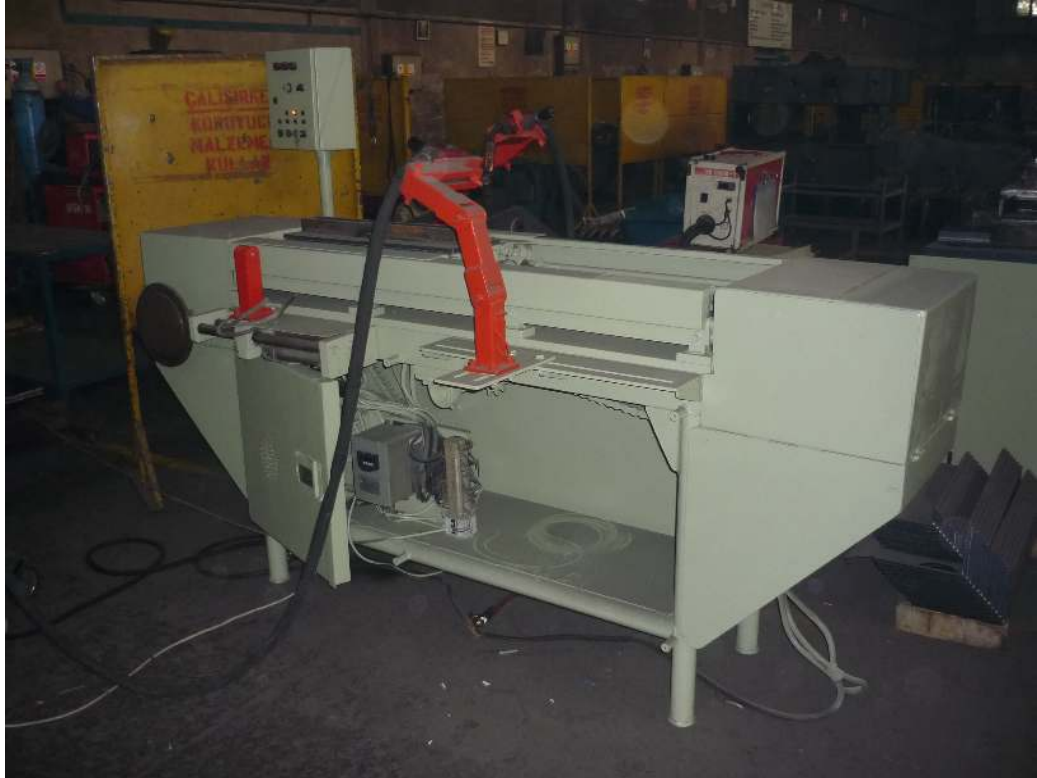
Şekil 5.1. Sacların kaynatılmasında kullanılan otomatik sistemin görünümü
