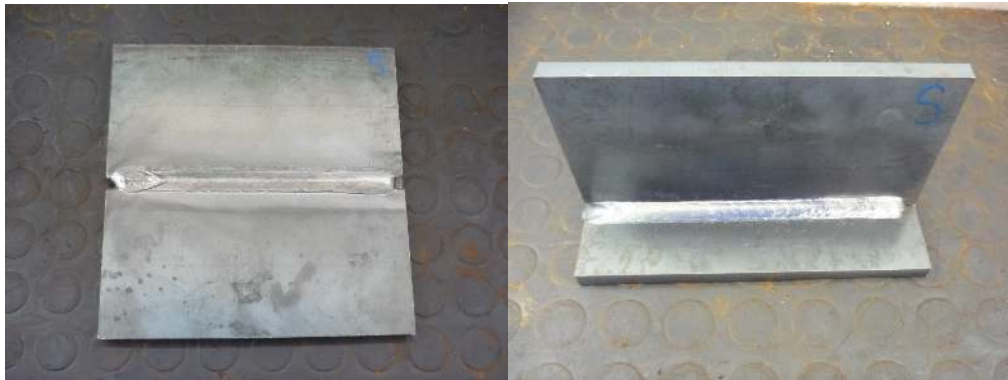
Şekil 5.11 Penetrent testi öncesi temizlenmiş plakalar
