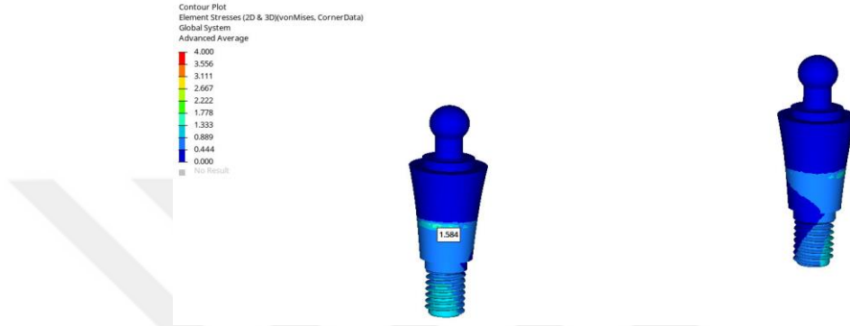
Şekil 4.24. Model 3' te ball abutmentlar üzerinde oluşan von Mises stresler ve dağılımları
