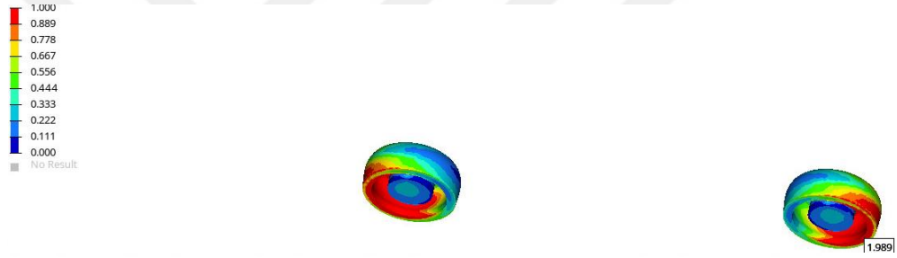
Şekil 4.34. Model 4’ te locator matriks üzerinde oluşan von Mises stresler ve dağılımları
