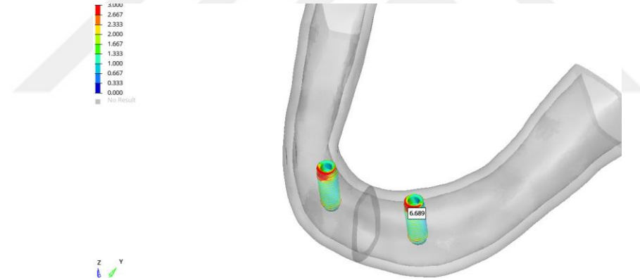
Şekil 4.32 Model 4’te implantta oluşan von Mises streslerin dağılımı
