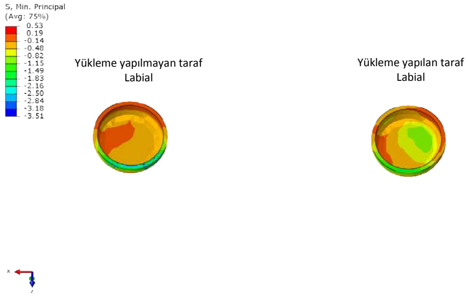
Şekil 4.136: 1. tasarımda housing parçada oluşan basma stresleri
