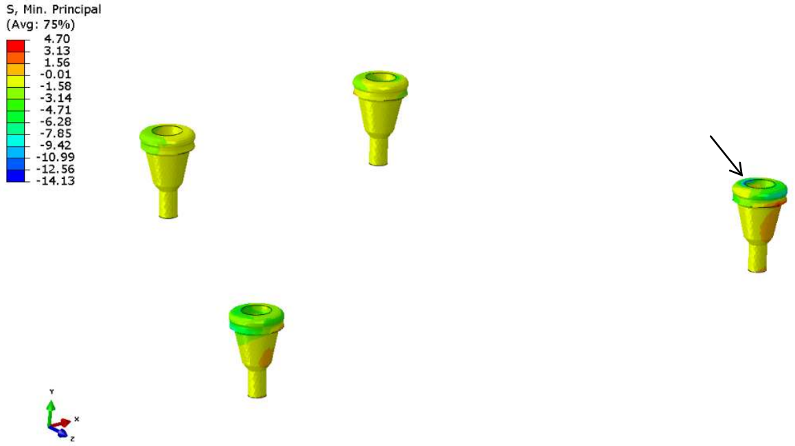
Şekil 4.155: 4. tasarımda locatorlarda oluşan basma stresleri
