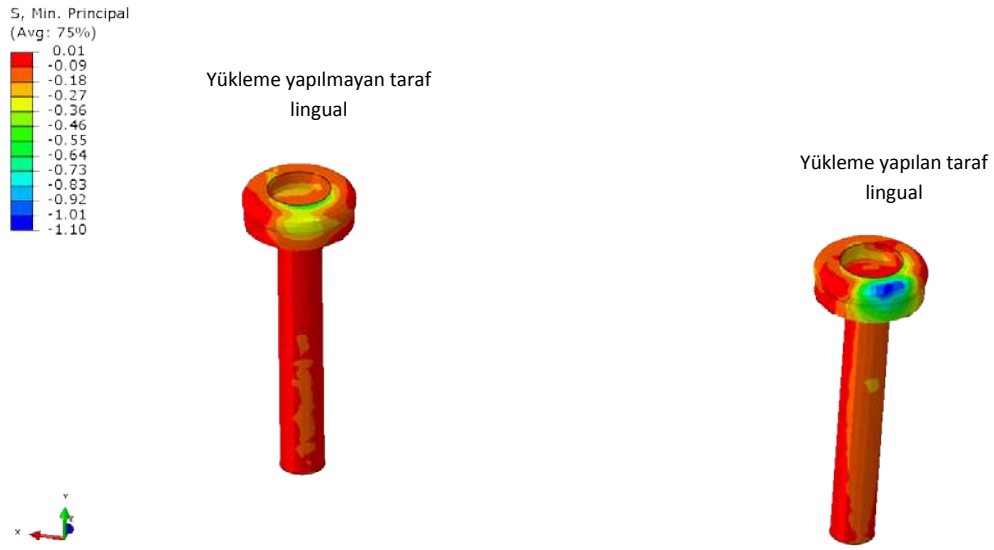
Şekil 4.153: 2. tasarımda locatorda oluşan basma stresleri
