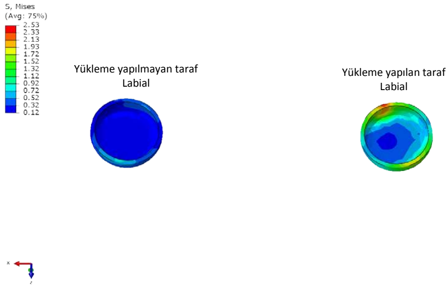
Şekil 4.142: 2. tasarımda housing parçada oluşan von Mises stresleri
