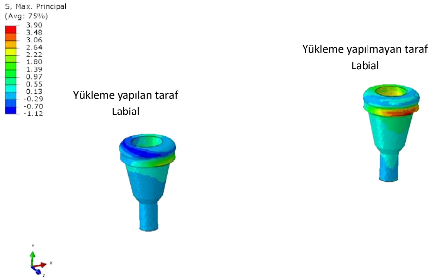
Şekil 4.147: 1. tasarımda locatorlarda oluşan çekme stresleri
