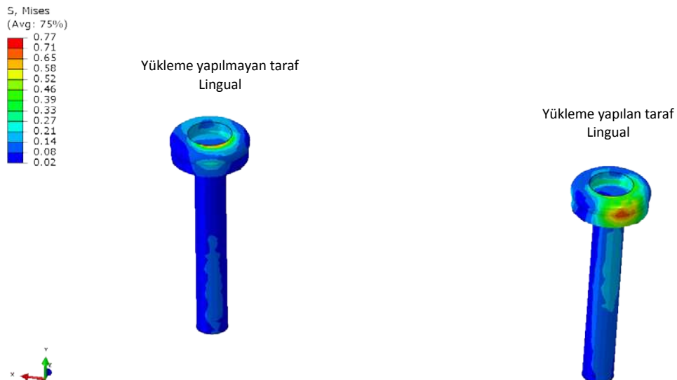
Şekil 4.158: 2. tasarımda locatorda oluşan von Mises stresleri
