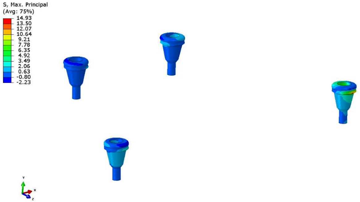
Şekil 4.150: 4. tasarımda locatorda oluşan çekme stresleri
