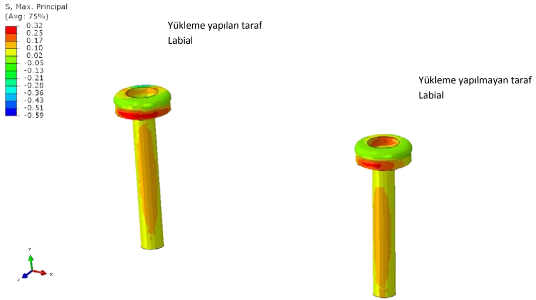
Şekil 4.148: 2. tasarımda locatorda oluşan çekme stresleri
