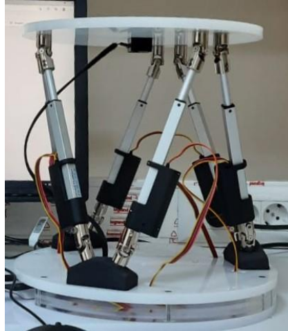
Şekil 3. 2 Tez çalışmasında kullanılan paralel mekanizma
