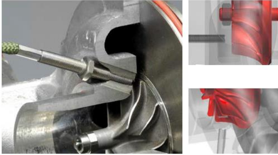
Şekil 3.6. Turboşaft hız sensörünün gösterimi [44].
