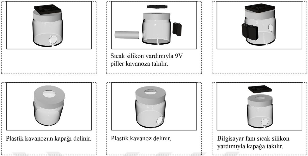
Şekil 2.30 Sis Makinası Montaj
