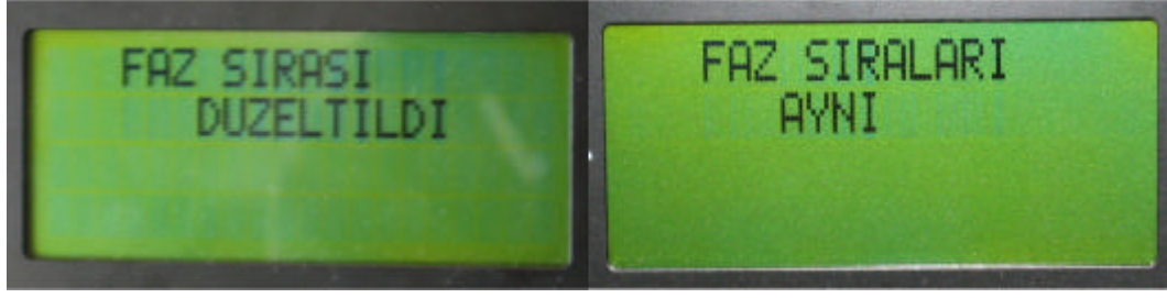
Resim 8.3. Faz sirasi LCD bilgileri resmi
