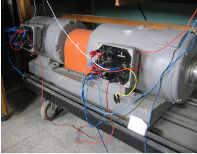
Resim 8.21. Deney setine ait DA motoru ve senkron motor(alternatör)
