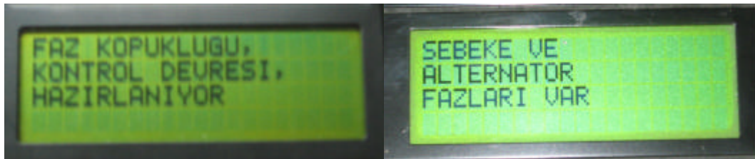
Resim 9.11. Sebeke ve alternatör fazlari LCD bilgisi
