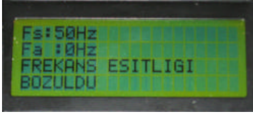
Resim 9.15. Frekans esitliği bozuldu LCD bilgisi
