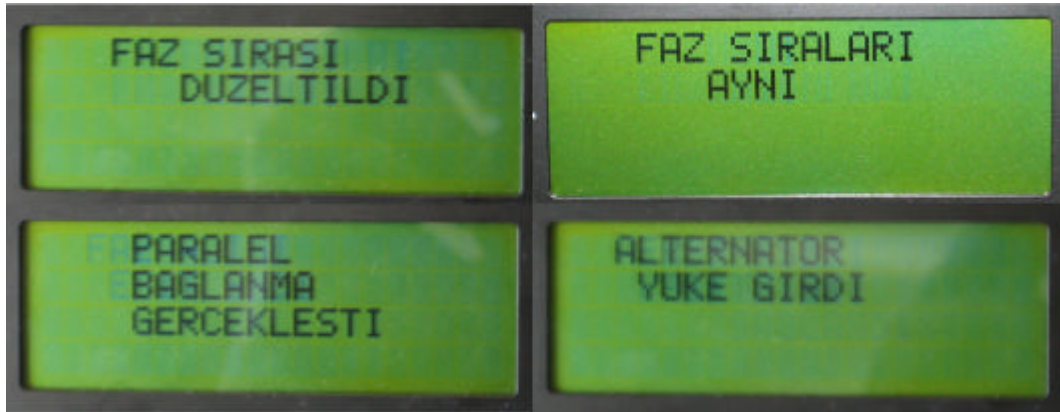
Resim 8.12. Röle ve sürme devreleri LCD bilgileri
