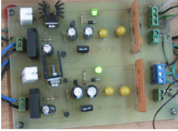
Resim 8.19. IGBT sürücü devre resmi
