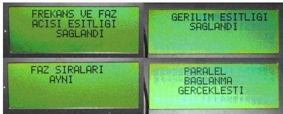
Sekil 13. LCD Ekran komut bilgileri (Informations of LCD screen statement)
