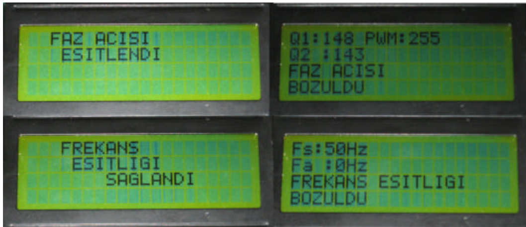
Resim 8.7. Faz açısı ve frekans eşitliği LCD bilgileri
