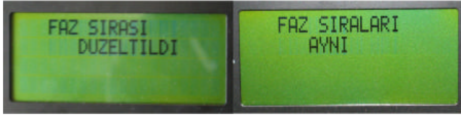
Resim 9.9. Faz sirasi LCD bilgisi
