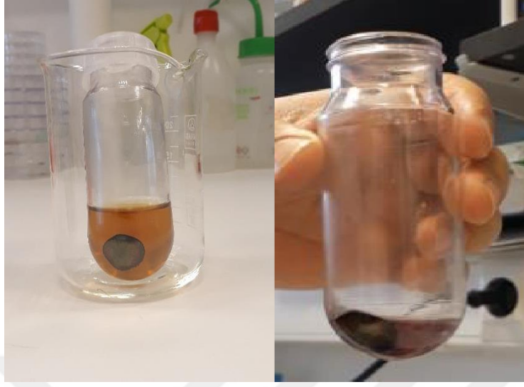
Fotoğraf 3.2. Sentez ve santrifüj sonrası çöken altın ve gümüş nanopartikül
