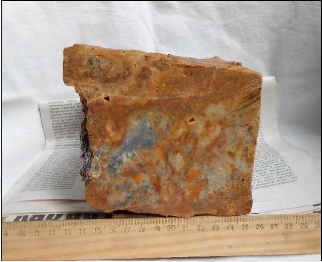
Şekil 3.2. Zengin zona ait oksitleşmiş ve yoğun cevherleşmiş kuvarsit görünümü
