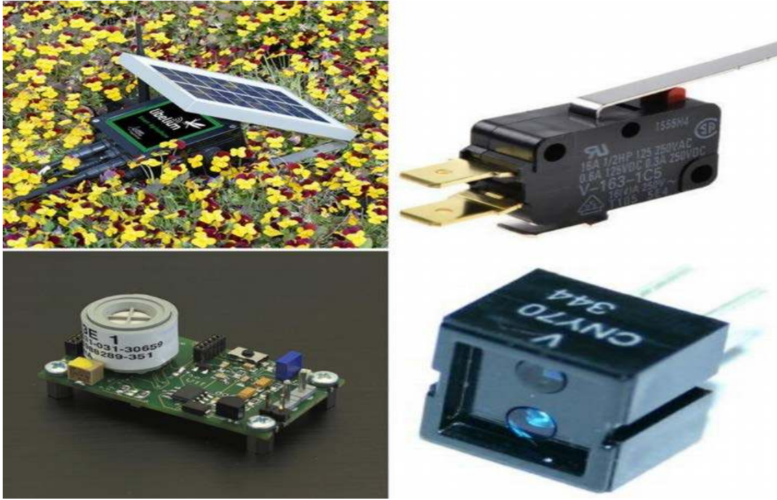
Resim 4.1 Akıllı Sensör Örnekleri: Sağ alt: Optik Sensör (Sandeckers), Sol alt: Elektrokimyasal Sensör (WUR), Sağ Üst: Mekanik Sensör (Lunatica Astronomical), Sol Üst: Meteorolojik Sensör (Libelium) (İban, 2019).
