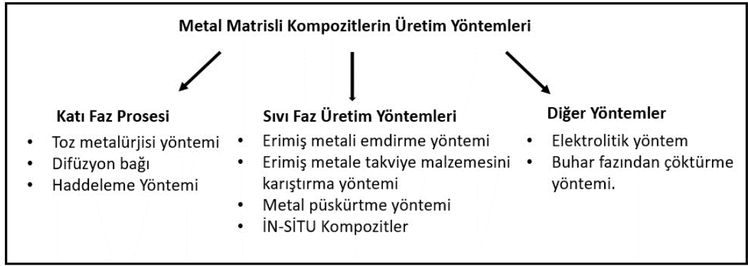
Şekil 2.3. Metal matrisli kompozit malzemelerin üretim yöntemleri.
