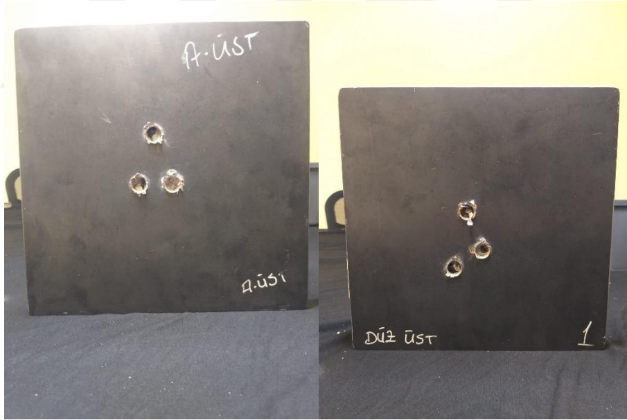
Şekil 4.6: Zırh numunelerine ateş edildikten sonra ön görüntüsü
