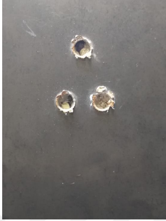
Şekil 4.9: Merminin altıgen geometrili zırha giriş görüntüsü
