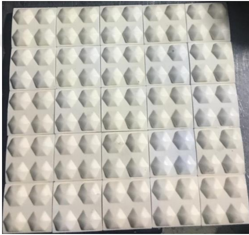
Şekil 3.16: Alümina seramik numunelerin tek çelik zırh plakasına yapıştırılmış hali
