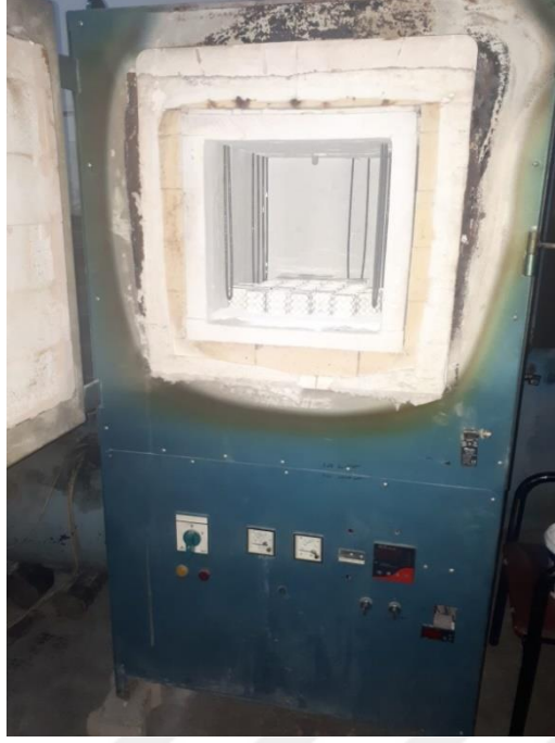
Şekil 3.12: Seramiklerin sinterlendiği fırın
