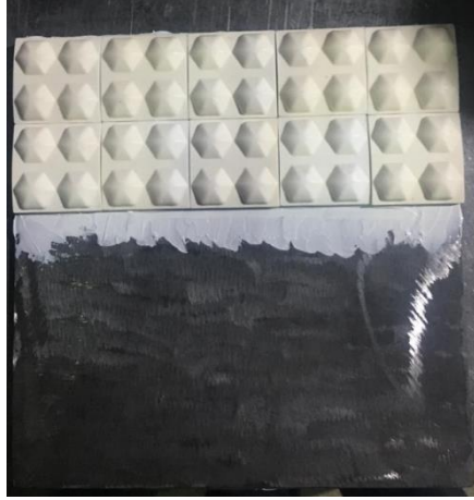
Şekil 3.15: Farklı geometrilerdeki seramik numunelerin çelik zırh plakasına yapıştırılması
