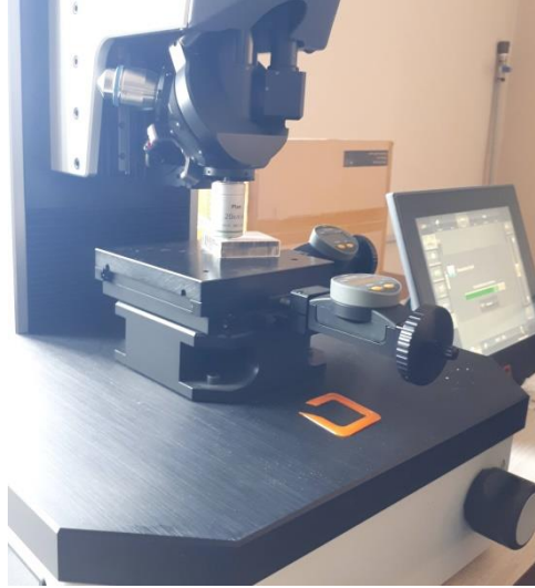
Şekil 3.14: Seramik numuneye sertlik testi uygulanma anı
