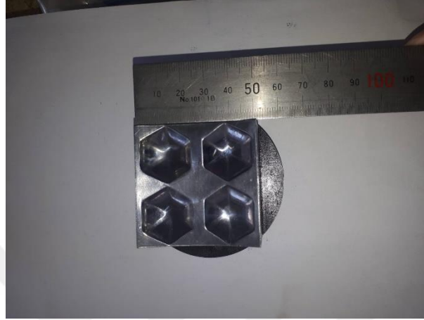
řekil 3.8: Altıgen kalıbın parlatma sonrasındaki görünüşü
