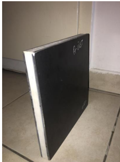
Şekil 3.17: Zırh numunenin birleştirildikten sonraki hali
