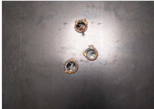
Şekil 4.8: Merminin düz geometrilili zırha giriş görüntüsü
