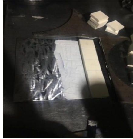
Şekil 3.15: Farklı geometrilerdeki seramik numunelerin çelik zırh plakasına yapıştırılması
