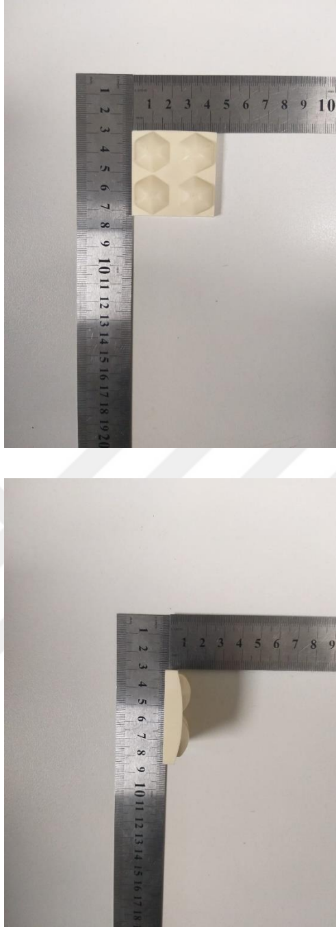
Şekil 4.5: Sinterleme sonrası altıgen geometrili alümina ölçü görüntüleri
