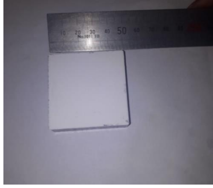
Şekil 4.1: Presleme sonrası düz şekilli alümina numune
