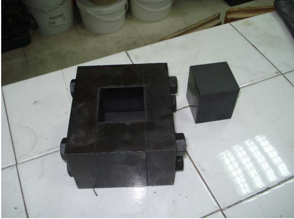
Resim 4.3. 50x50 iç boşluğa sahip kalıp
