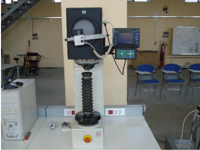
Resim 4.8. Makro sertlik ölçüm cihazı
