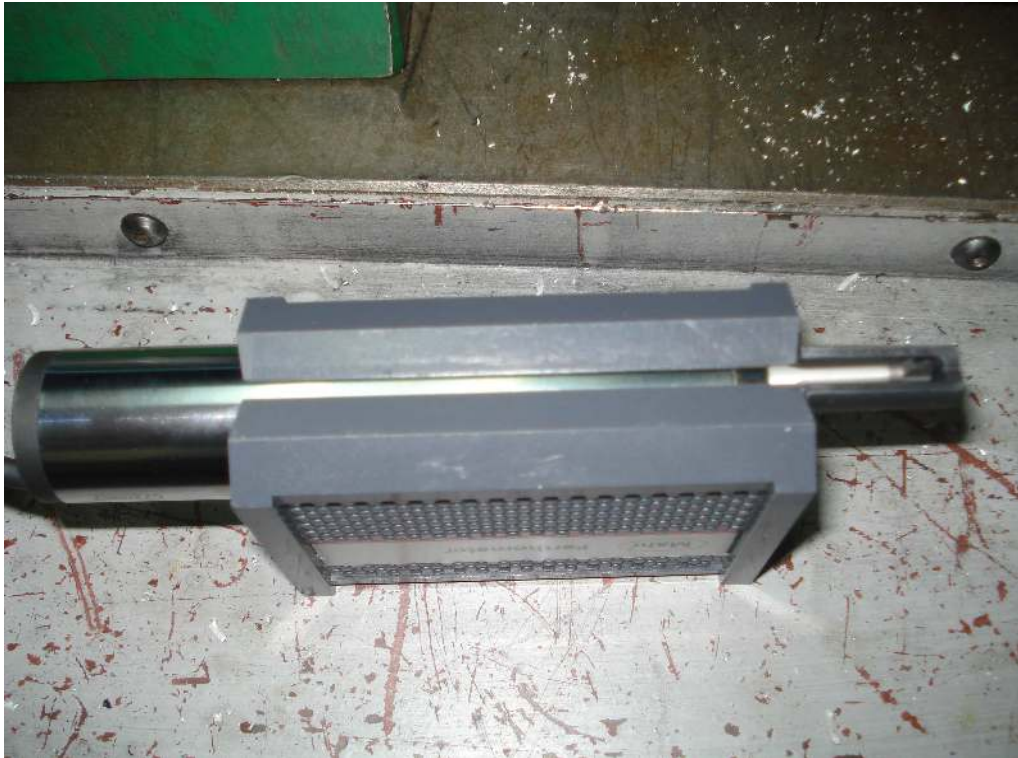
Resim 4.18. Perthometer M1 (Mahr) yüzey pürüzlülüğü ölçüm cihazının ucu
