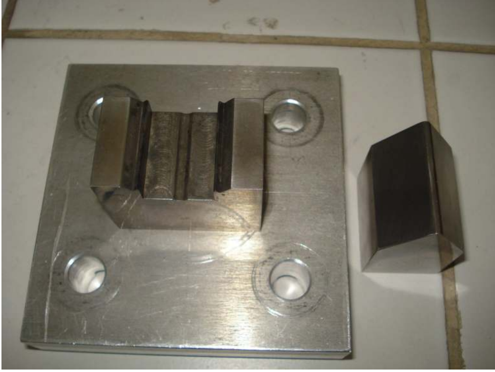
Resim 4.9. Üç nokta eğme deneyi düzeneği - 1
