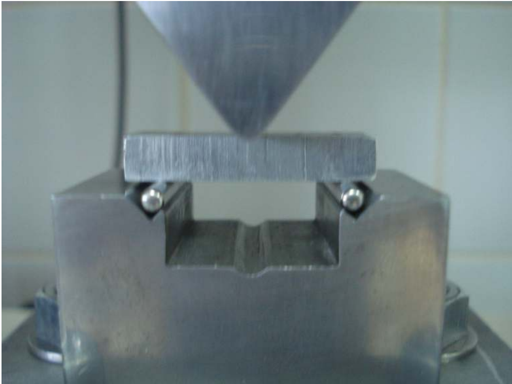
Resim 4.10. Üç nokta eğme deneyi düzeneği - 2
