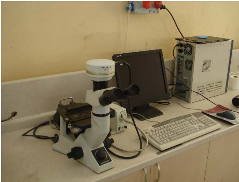
Resim 4.7. Optik mikroskop düzeneği
