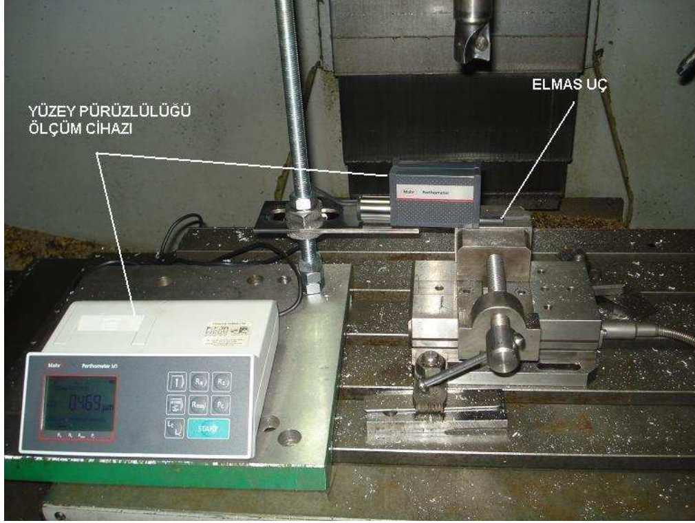
Resim 4.17. Perthometer M1 (Mahr) yüzey pürüzlülüğü ölçüm cihazı
