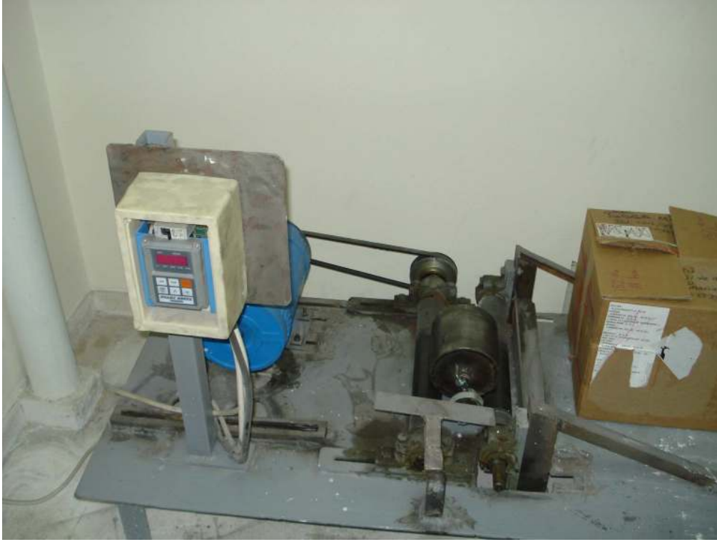
Resim 4.2. İki boyutlu toz karıştırma birimi
