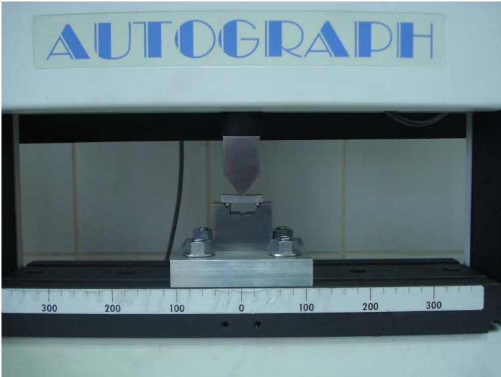
Resim 4.12. Üç nokta eğme deneyi düzeneği - 4
