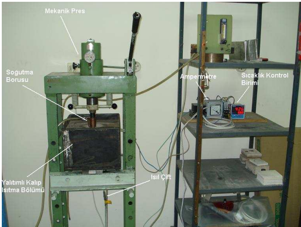
Resim 4.4. 30 ton kapasiteli mekanik pres ve elektrik fırını düzeneği
