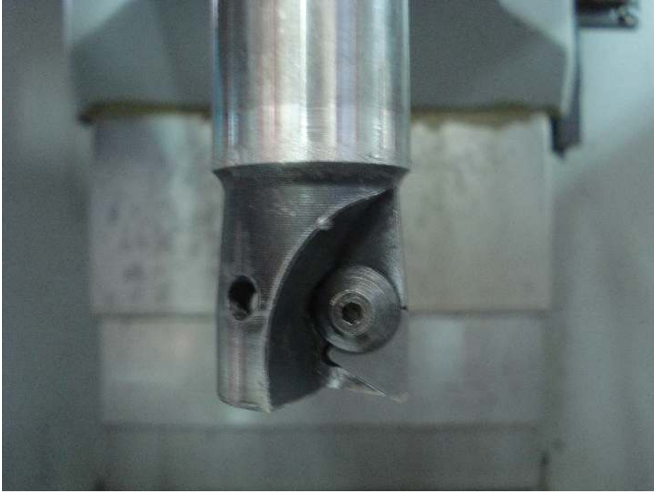
Resim 4.16. Takım tutucuya kesici takımın bağlantı şekli
