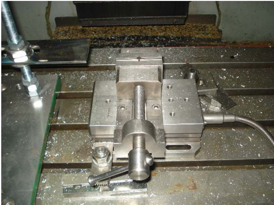
Resim 4.13. İş parçası bağlama aparatı ve KISTLER 9257B dinamometre
