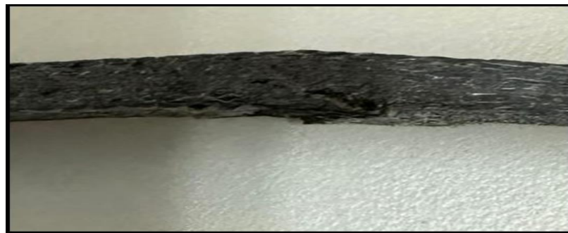
Şekil 5. 47 : Hidroklorik asitli sudan çıkarılın 3 nokt eğilme numunesi kısa kenar yan kesit deformasyonları makro fotoğrafı
