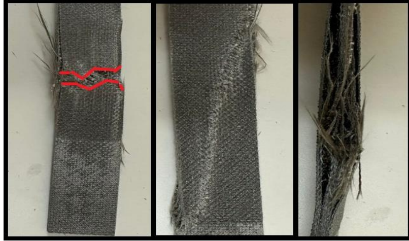
Şekil 5. 24 : Alümina katkısız HCl li su ortamından çıkarılan numunelerin 2.ay çekme testi
