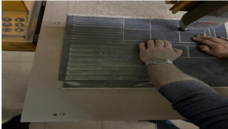
Şekil 4. 8 : Router Kesim Cihazı ile Numune Kesim İşlemi
