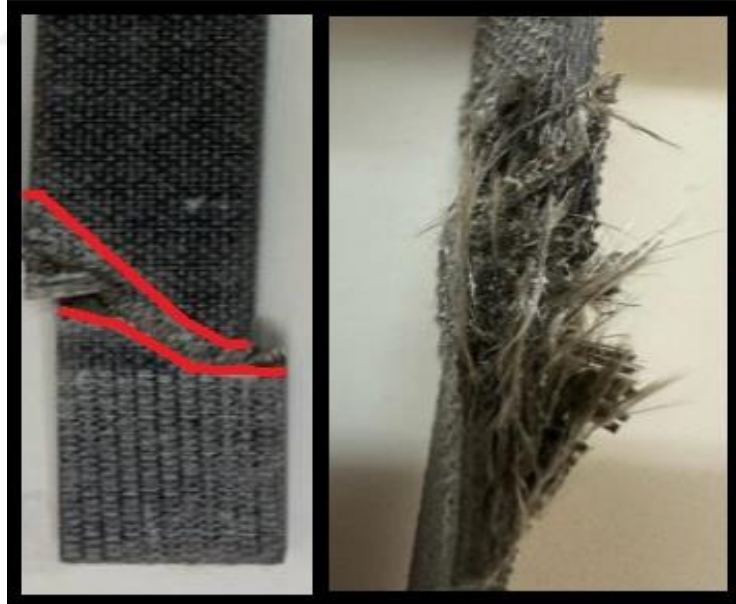
Şekil 5. 16: Alümina katkılı 1. ay hcl li su ortamından çıkarılan numunelerin çekme test fotoğrafları
