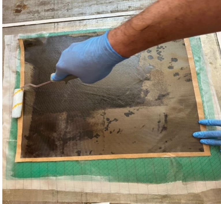
Şekil 4. 6 : El Yatırma Yöntemi veTorbalama Vakum İnfüzyon Yöntemi İle Bazalt Fiber Üretimi
