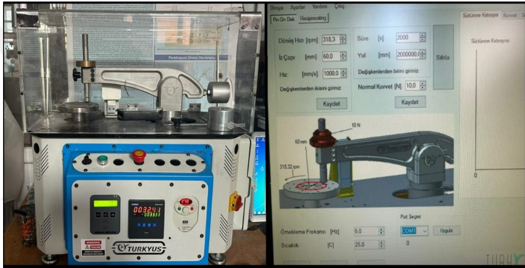
Şekil 4. 14 : Pin On Disk Aşınma Test Cihazına Parametrelerin Girilmesi
