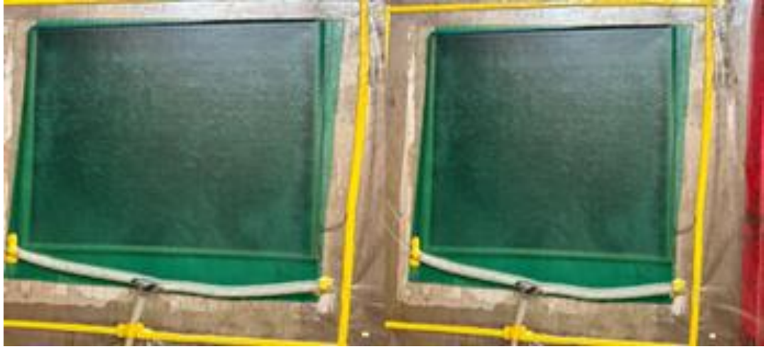
Şekil 4. 7 : El Yatırma Yöntemi ve Torbalama Vakum İnfüzyon Yöntemi İle Bazalt Kompozit Plaka Üretimi
