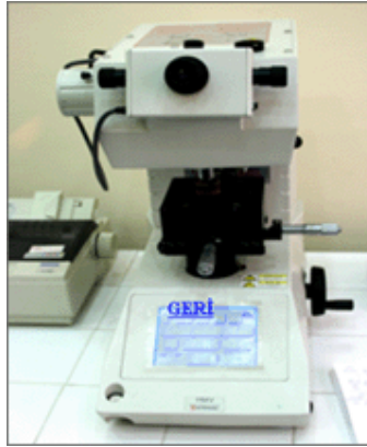
Şekil 2.5. SHIMADZU HMV-2 Model sertlik cihazı
