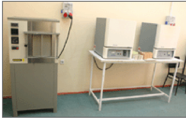
Şekil 2.4. Nabertherm marka 1750 °C'lik yüksek sıcaklık fırını (solda)
