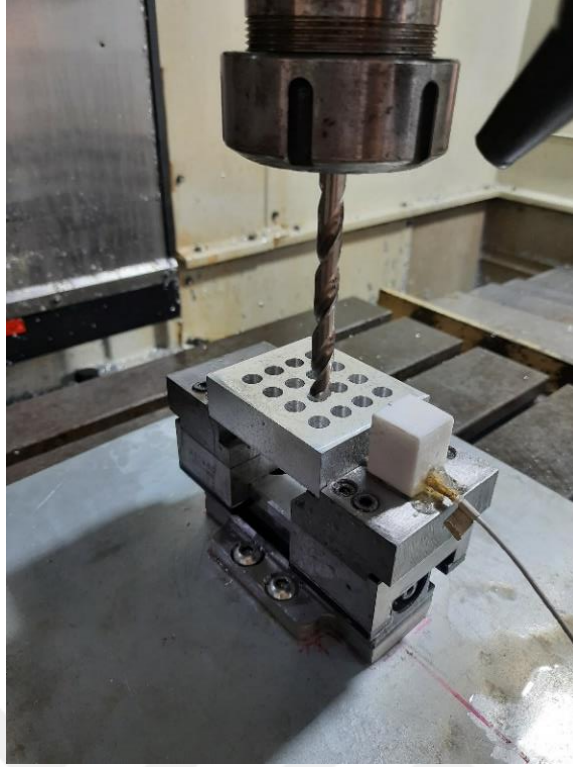
Şekil 4.4. HSS matkap ile delik delinen numune.
