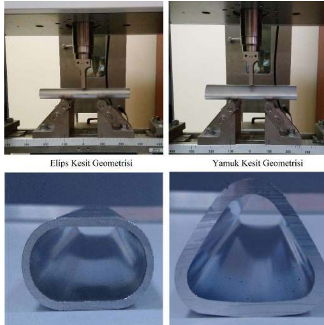
Şekil 4.3. İki farklı kesit geometrisine sahip deforme olmamış profiller
