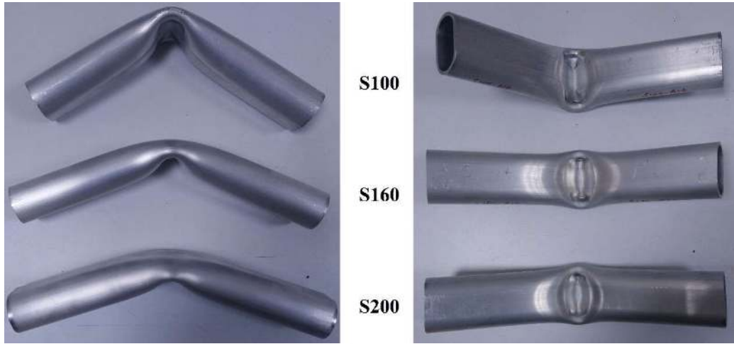
Şekil 4.6. Elips kesit geometrisinin R10 zımba yarıçapı için farklı mesnet mesafelerinde deforme olmuş formları
