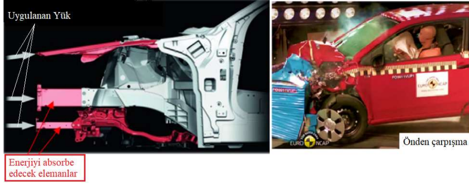
Şekil 2.5 Eksenel yükleme şematik gösterimi
