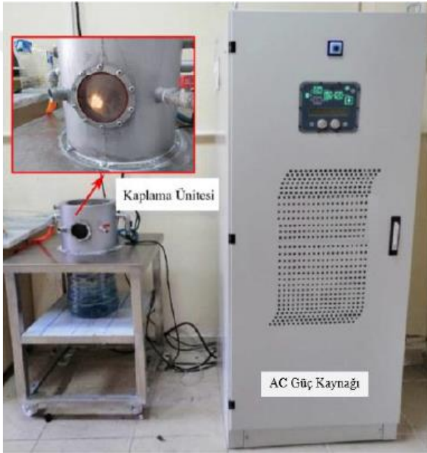
Şekil 26. Mikro Ark Oksidasyon (MAO) kaplama ünitesi
