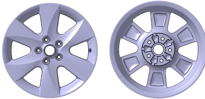
Şekil 3.16 S-N eğrisi eldesinde kullanılacak jant modeli
