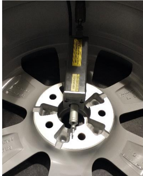
Şekil 3.17 Offset bölgesi yüzey pürüzlülüğü ölçümü (Kişisel arşiv, 2018)
