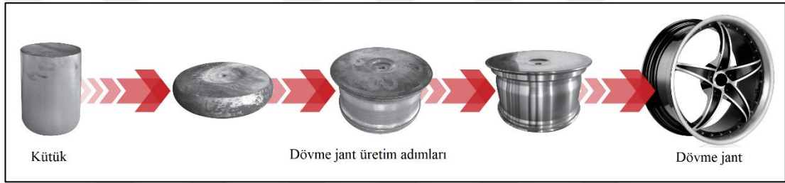
Şekil 2.5 Dövme jant üretim süreci (Alexrims Wheels, 2018)
