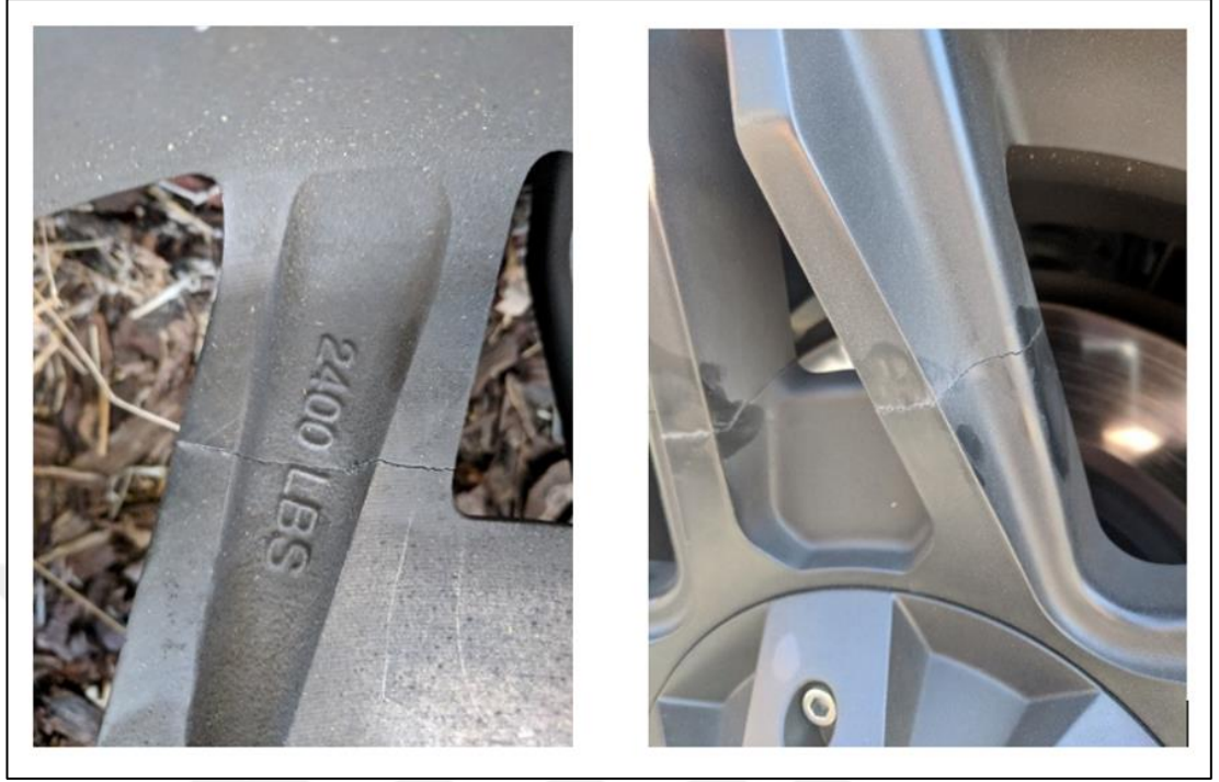
Şekil 3.7 Yorulma hasarına uğramış jant (Horsepowerhub, 2018)
