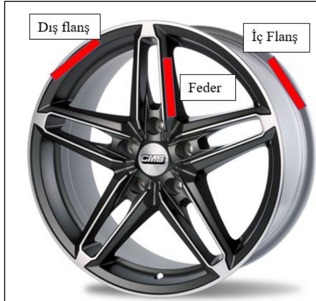
Şekil 3.15 Çekme çubuğu numune bölgeleri (CMS, b.t.)
