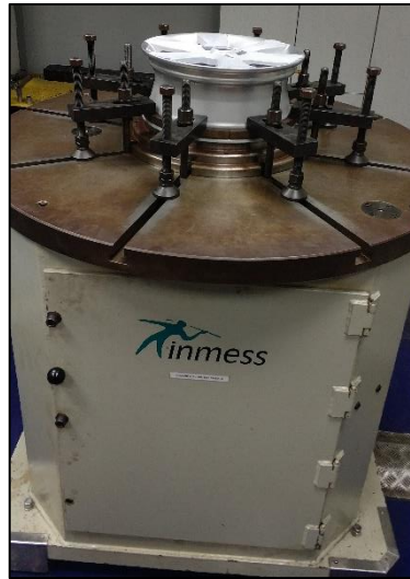
Şekil 3.23 INMESS dinamik viraj yorulması test cihazı (Kişisel arşiv, 2018)
