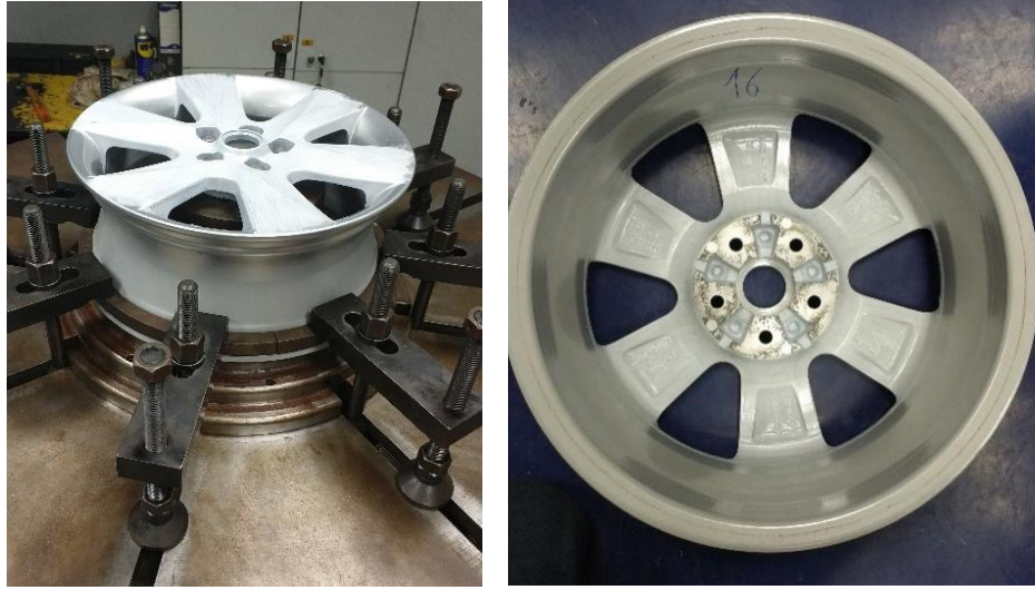
Şekil 3.18 S-N eğrisi belirleme deneyleri (Kişisel arşiv, 2018)
