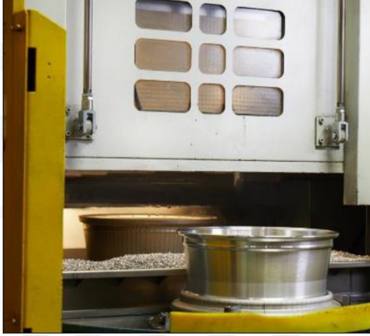
Şekil 2.10 Alüminyum alaşımlı jantın talaş kaldırma işlemi (Karakaş, 2020)
