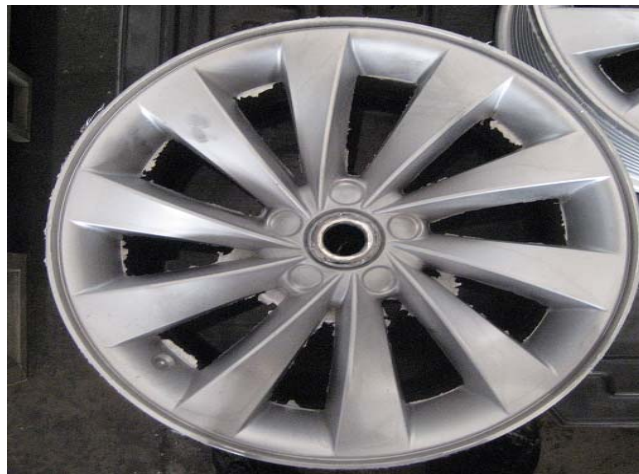
Şekil 3.3 Alçak basınç döküm tekniğiyle dökülmüş bir jant (Demir, 2007)
