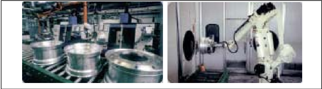
Şekil 1.3 Dövme jant delik açımı ve parlatma (Alcoa, bt, www.noregt.com ).
