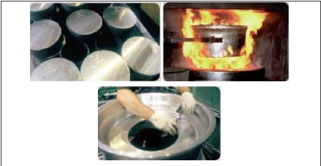
Şekil 1.2 Dövme jant yapım aşaması (Alcoa, bt, www.noregt.com ).
