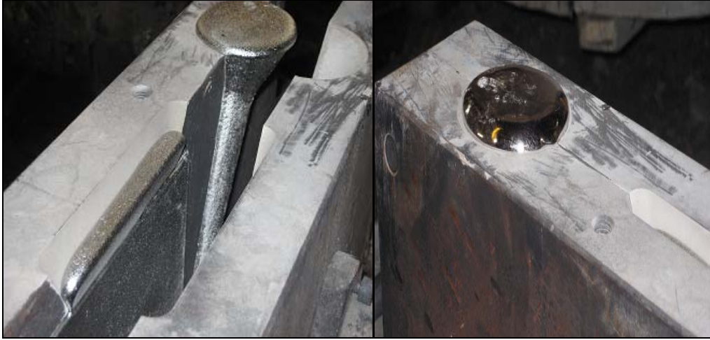
Şekil 5.5 Parçanın kalıp içerisindeki durumu
