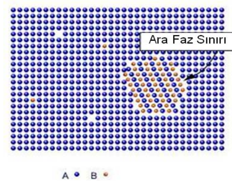
Şekil 4.8 Yaşlandırma işleminde son kademe yapı değişimi (alumatter,bt, http://aluminium.matter.org.uk )
