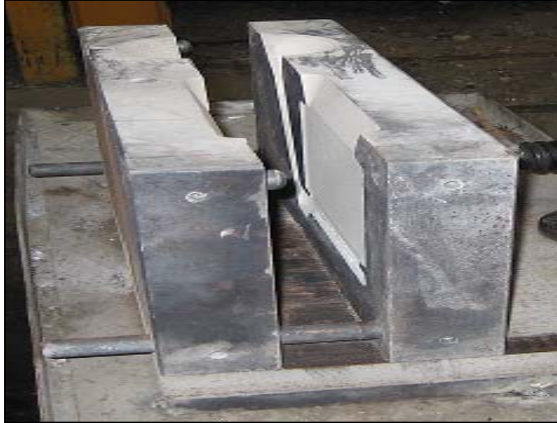
Şekil 5. 3 Poteyajlı kalıp (Demir, 2007)
