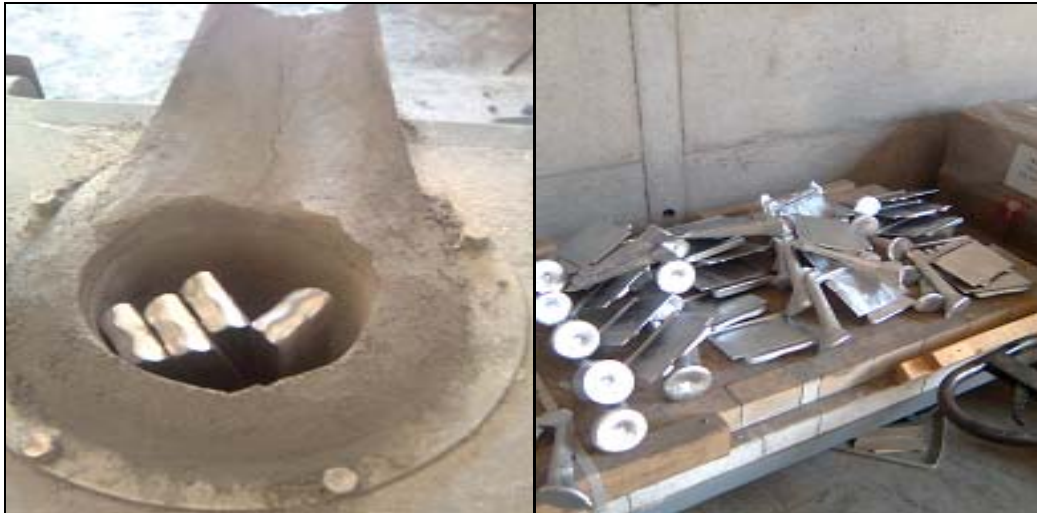
Şekil 5.6 Parçaların kalıptan sonraki durumu ve külçe ergitilmesi
