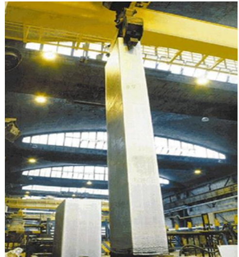
Şekil3.2 Doğrudan Soğutma ile Üretim
