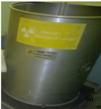
Şekil 4.9 : a) Nötron howitzer’ in a) dış görünüşü b) iç yapısı.
