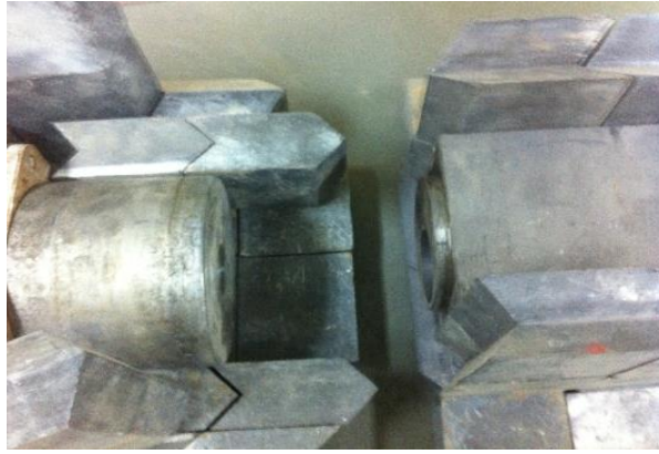
Şekil 4.7 : Kurşundan yapılmış kolimatörlerin görüntüsü.
