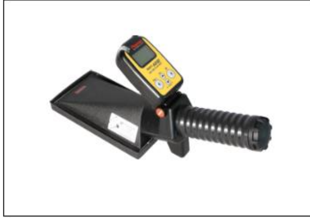
Şekil 4.15 : RadEye marka AB100 model \alpha,\beta ölçüm dedektörü.
