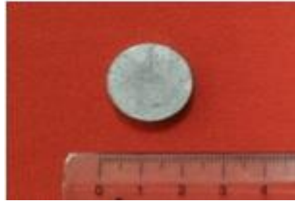
Şekil 7.1 : Alüminyum- bor karbür- tungsten karbür hibrit kompozit malzemelerin genel görüntüleri.
