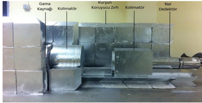
Şekil 4.4 : Gama deney düzeneğinin görünümü.
