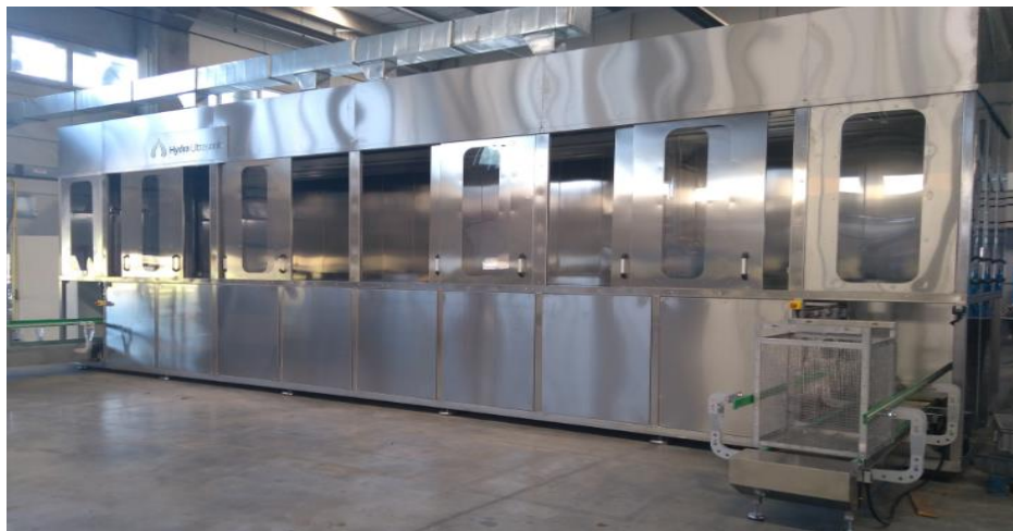
Resim 3.4. Alüminyum Ultrasonik Yıkama Ünitesi
