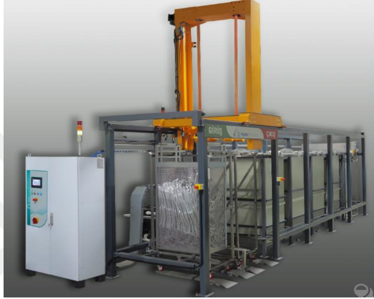
Resim 3.3. Alüminyum Yıkama Ünitesi
