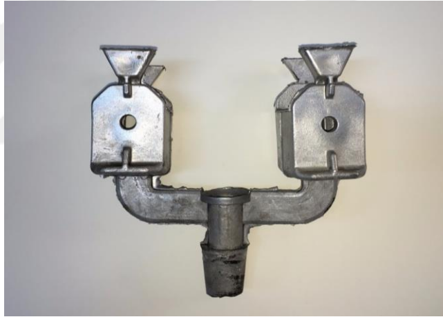
Şekil 4.3 Alçak basınç döküm yöntemiyle üretilen parçası
