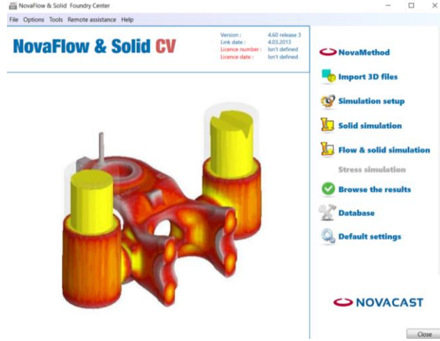
Şekil 3.3 Kokil döküm için Novacast döküm simülasyon programı arayüzü
