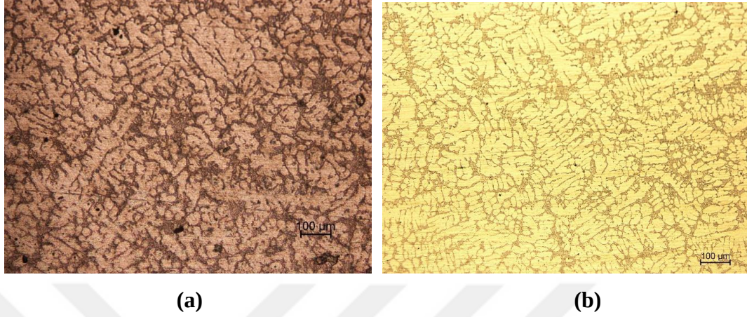
Şekil 4.5 SDAS değerlerini hesaplamak için kullanılan 10X büyütmede (a) kokil döküm parçası, (b) alçak basınç döküm parçası
