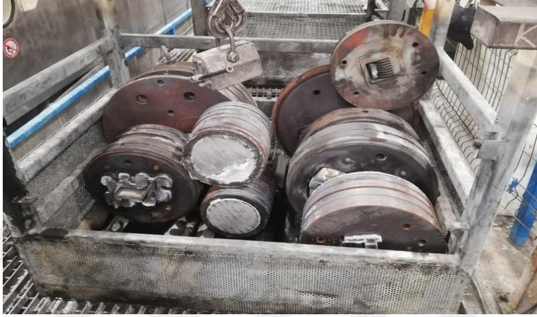
Şekil 2.19. Kalıpların Temizleme Öncesi Sepet İçi Yerleşimleri
