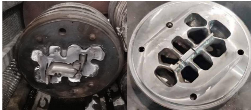
Şekil 2.18. Temizleme İşlemi Öncesi ve Temizleme İşlemi Sonrası
