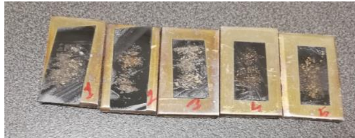
Şekil 5.10. Au/Pd kaplı toz numuneler
