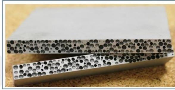
Şekil 1.9. Alüminyum matrisli kompozit yapı (Değirmenci, 2019)
