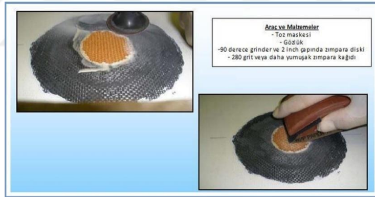
Şekil 6.9. Çekirdek yüzeyinin düzeltilmesi (Karaer, 2014)
