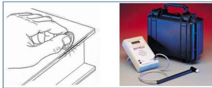
Şekil 5.3. Tap test kontrolünde kullanılan araç ve gereçler (Karaer, 2014)
