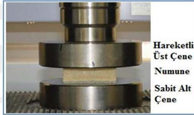
Şekil 3.4. Basma testi cihazında örnek numune (Bitzer, 2012)
