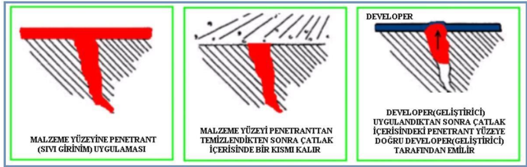
Şekil 5.7. Penetrant sıvı kontrolünün temel prensibi (General Dynamics, 1996)
