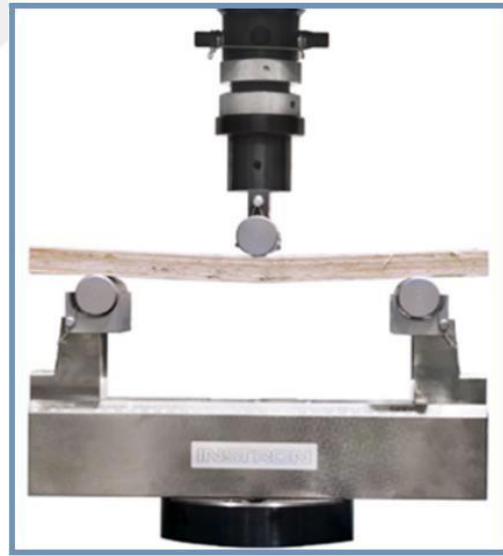
Şekil 3.5. Eğme testi cihazında numuneye kuvvet uygulanması (Fibre-Reinforced Plastic Composite, 1998)
