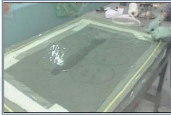
Şekil 6.16. Vakum ile kumaşın reçineye emdirilmesi (Karaer, 2014)
