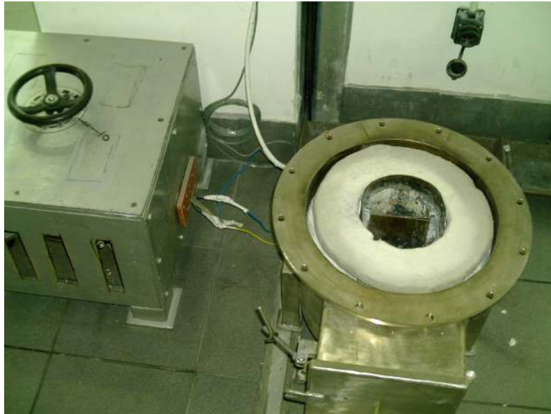
Şekil 5.12 Alüminyum köpük metal üretiminde kullanılan deney düzeneğinin üst görünüşü
