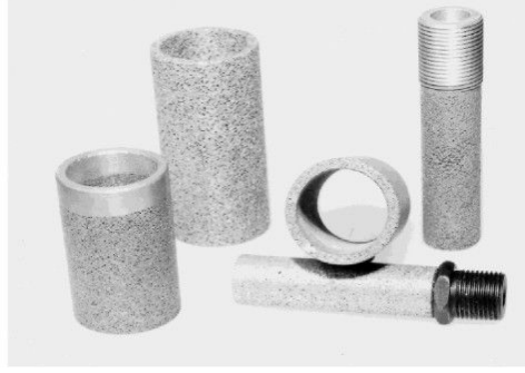
Şekil 3.12 Alüminyum köpükten yapılmış susturucular (Banhart, 2000b).
