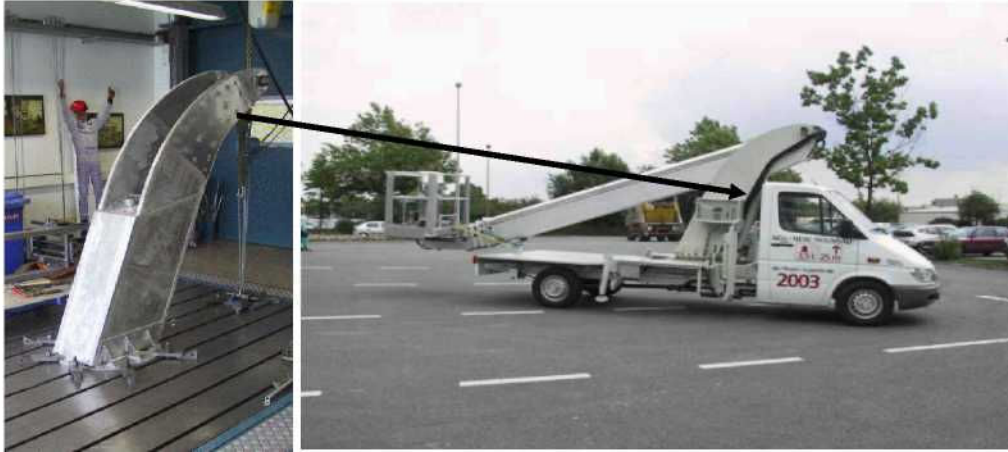
Şekil 3.4 Alüminyum sandviç panelden yapılmış bir kaldırma kolu (Banhart, 2003).
