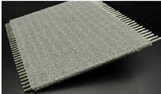
Şekil 3.10 Köpük metal ısı değiştirici (Haack vd., 2002 ).
