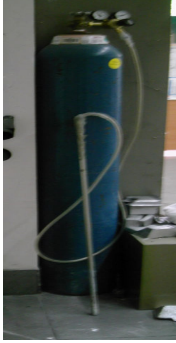
Şekil 5.10 Gaz üfleme sistemi.
