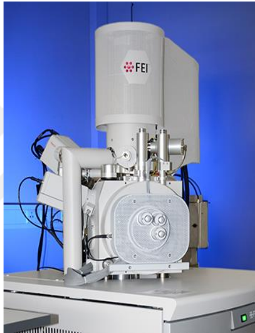
Şekil 5.6. İncelemerde kullanılan FESEM Cihazı
