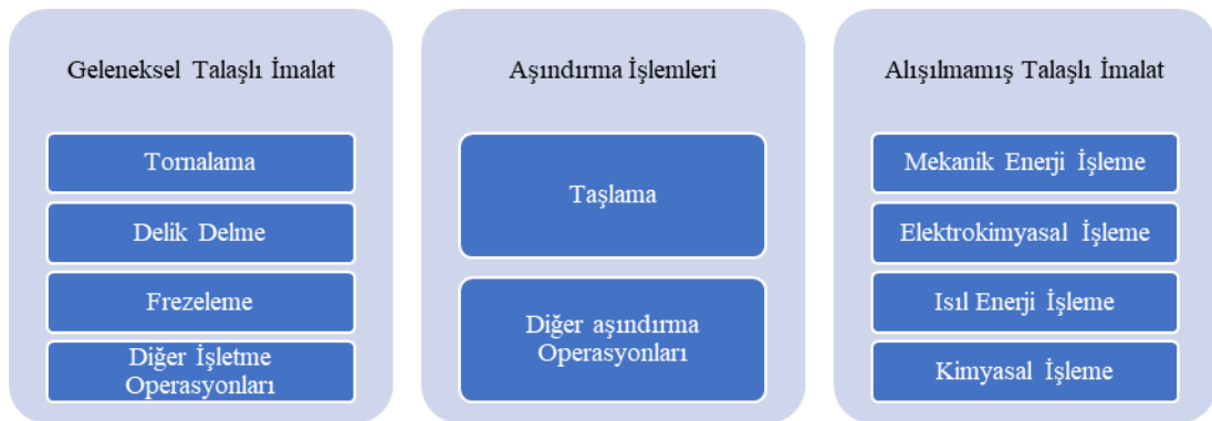
Şekil 2.3. Malzeme kaldırma İşlemleri sınıflandırılması
