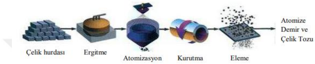
Şekil 2.7. Atomizasyon ile toz üretim aşamaları [41]
