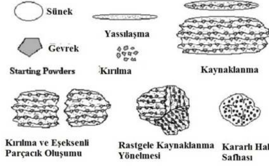
Şekil 3.4. Sünek-gevrek mekanik alaşımlama sisteminin aşamaları[9].
