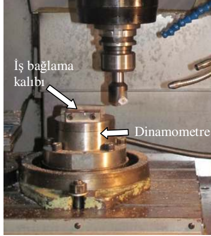
Resim 6.7. MMK numunelerin bağlama aparatına bağlanması
