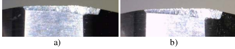
Resim 7.18. %10 B 4 C takviyeli MMK'in kaplamasız SK takım ile 5~6 mm işlenmesinde esas kesme kenarı yan yüzeyinde oluşan aşınmalar a) 50 m/min, b) 110 m/min kesme hızında
