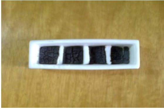
Resim 3.4. Sinterleme işleminden sonra elde edilen bor karbür numuneleri
