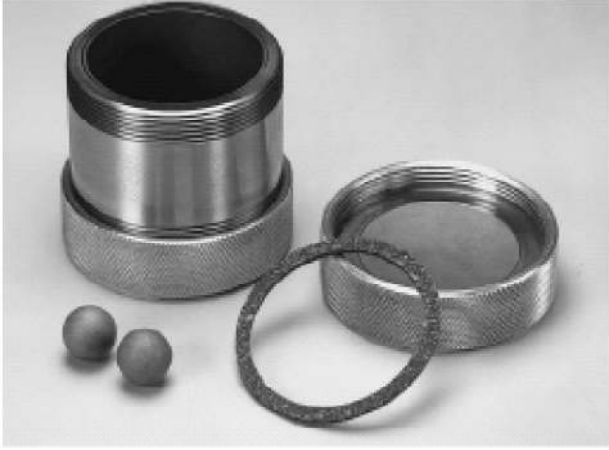
Şekil 2.5. Tungsten karbür' den yapılmış SPEX tipi karıştırıcının; öğütme kabı, kapak, conta ve bilyalardan oluşan öğütme hücresi
