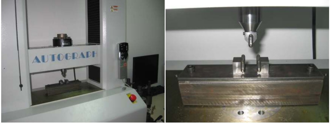
Şekil 3.13. İmal ettirilmiş olan üç nokta eğme aparatının fotoğrafları
