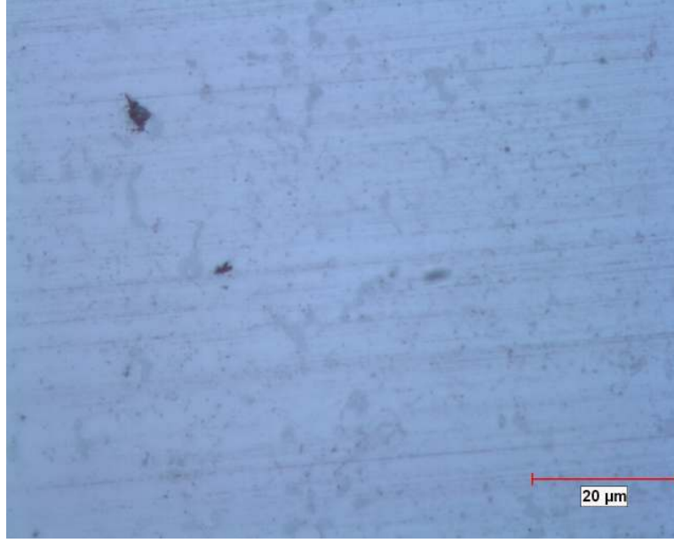
Şekil 4.1. Destek fazı içermeyen Al-%4Cu alaşıımının mikroyapısı (1000X)
