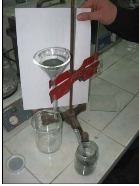
Şekil 3.5. SiC partiküllerinin kaplama çözeltisinden filtre edilerek ayrılması
