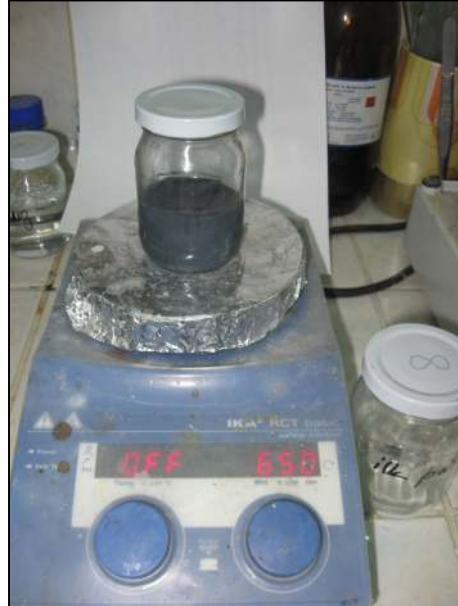
Şekil 3.4. Kaplama çözeltisine SiC partiküllerinin eklenmesi ve karıştırılması
