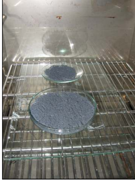
Şekil 3.6. Filtre edilen SiC partiküllerinin dağıtılması ve 120 °C’de 2 saat kurutulması
