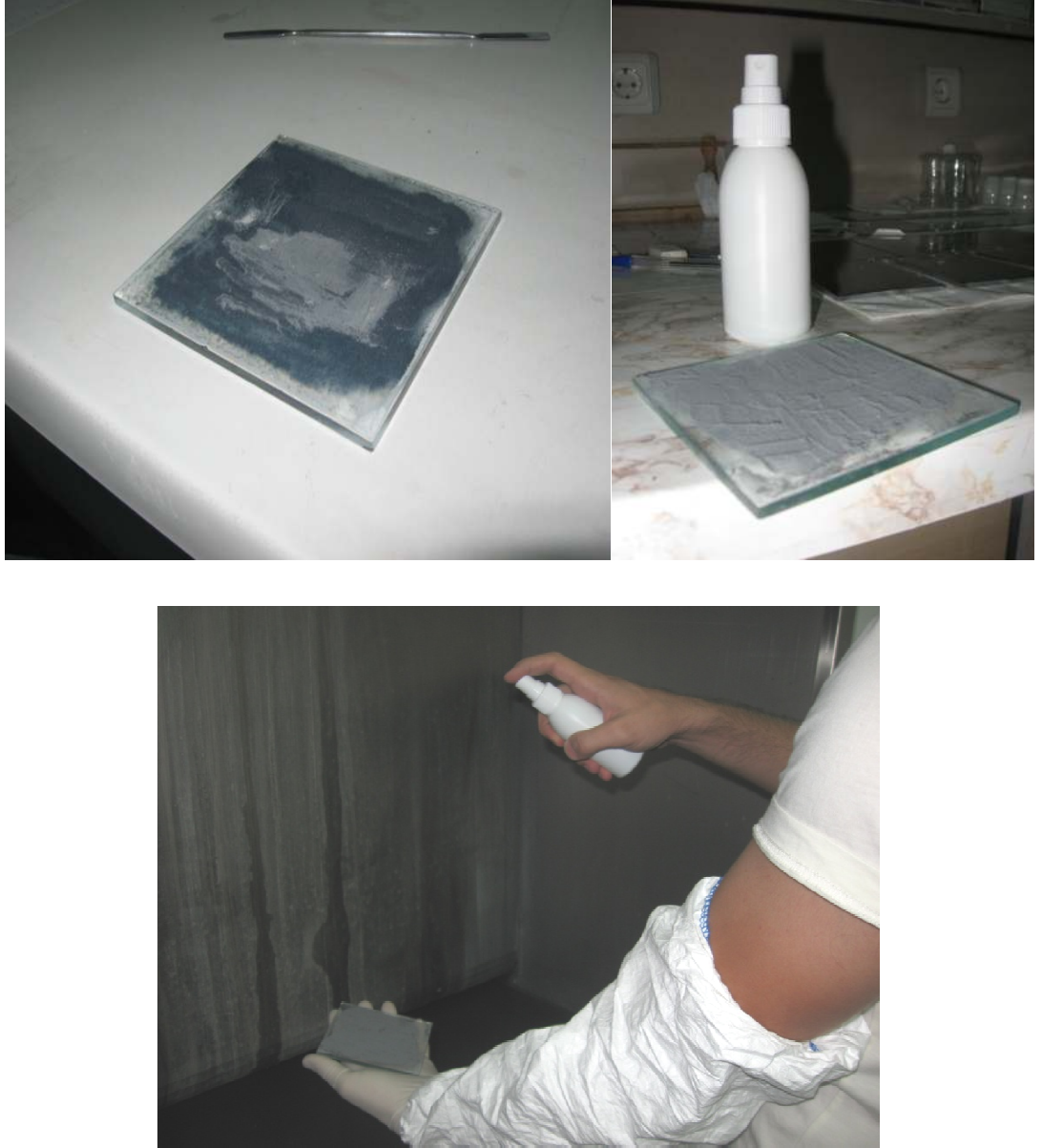
Şekil 3.8. Filtre edilen SiC partiküllerinin dağıtılması ve 120 °C’de 2 saat kurutulması Seramik partiküllerin silika çözeltisi ile sprej yöntemiyle kaplanması
