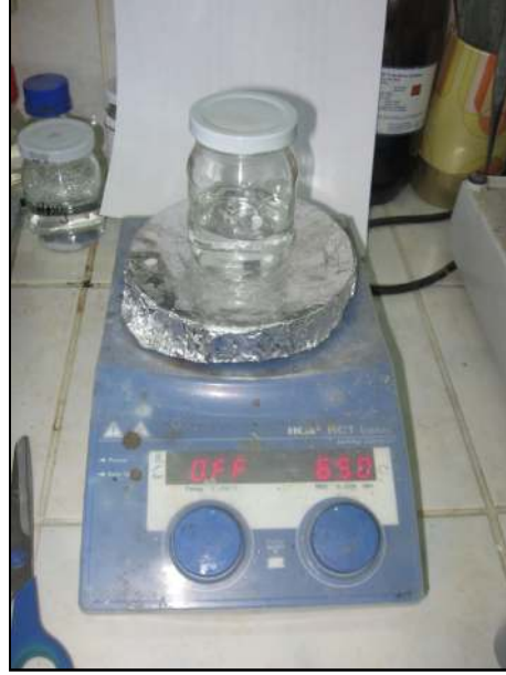
Şekil 3.3. Kaplama çözeltisinin hazırlanması ve 2 saat süreyle hidroliz edilmesi
