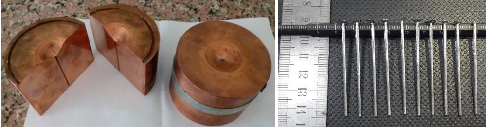
Resim 3.2 Döküm işlemlerinde kullanılan bakır kalıplar ve üretilen amorf \text{Co}_{42}\text{Cu}_1\text{Fe}_{20}\text{Ta}_{5.5}\text{B}_{26.5}\text{Si}_5 alaşım numuneleri.
