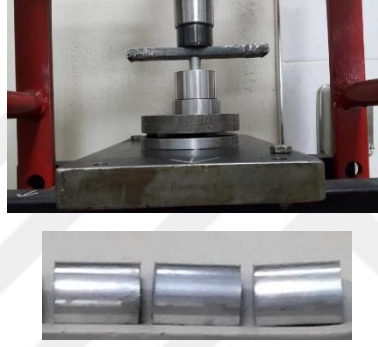
Resim 3.4 Deneyisel çalışmalarda kullanılan hidrolik pres, şekillendirme kalıbı ve üretilen numuneler.
