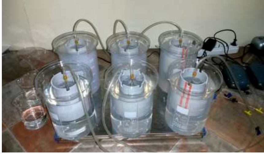
Şekil 8. Larvalara zarar vermeden dönme hareketi yaparak homojen bir nanopartikül karışım ortamı sağlayan yarı-izole toksikolojik test sistemi.
