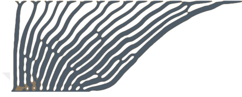
Şekil 4.6. Ağırlıkça %75 hafifletilmiş ısı alıcı geometrisi
