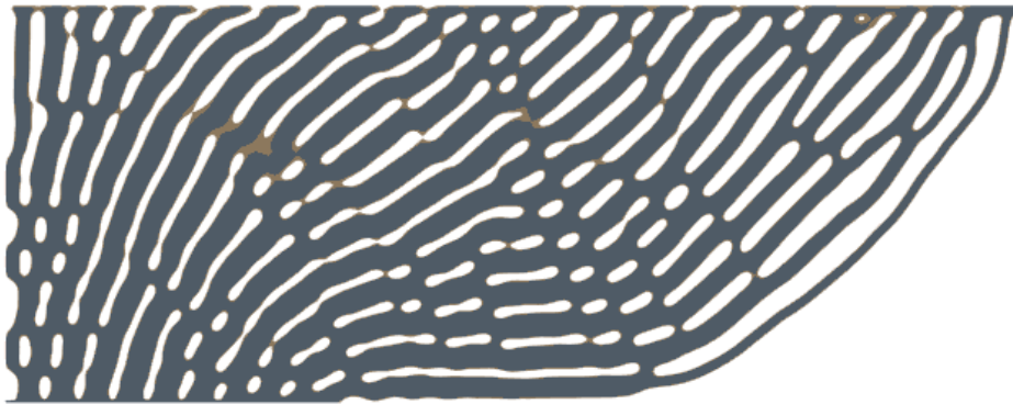
Şekil 4.1. Ağırlıkça %50 hafifletilmiş ısı alıcı geometrisi
