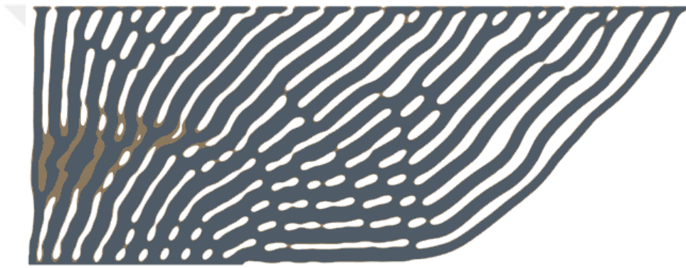
Şekil 4.2. Ağırlıkça %55 hafifletilmiş ısı alıcı geometrisi
