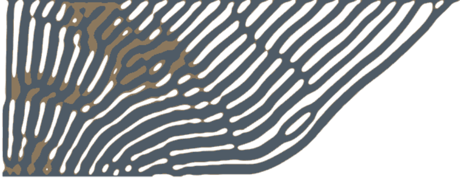
řekil 4.3. Ağırlıka %60 hafifletilmiř ısı alıcı geometrisi
