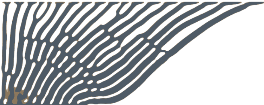
řekil 4.5. Ağırlıka %70 hafifletilmiř ısı alıcı geometrisi
