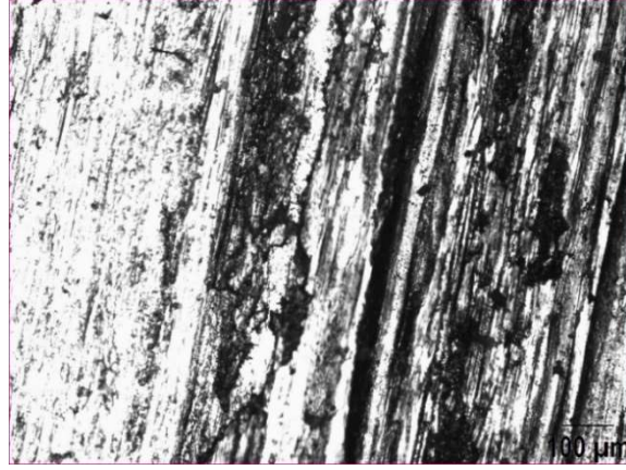
Şekil 5.16. S4 numunesinin aşınmış yüzeyinin 2500 m’lik alınan yol sonundaki optik mikroskop resmi, X100
