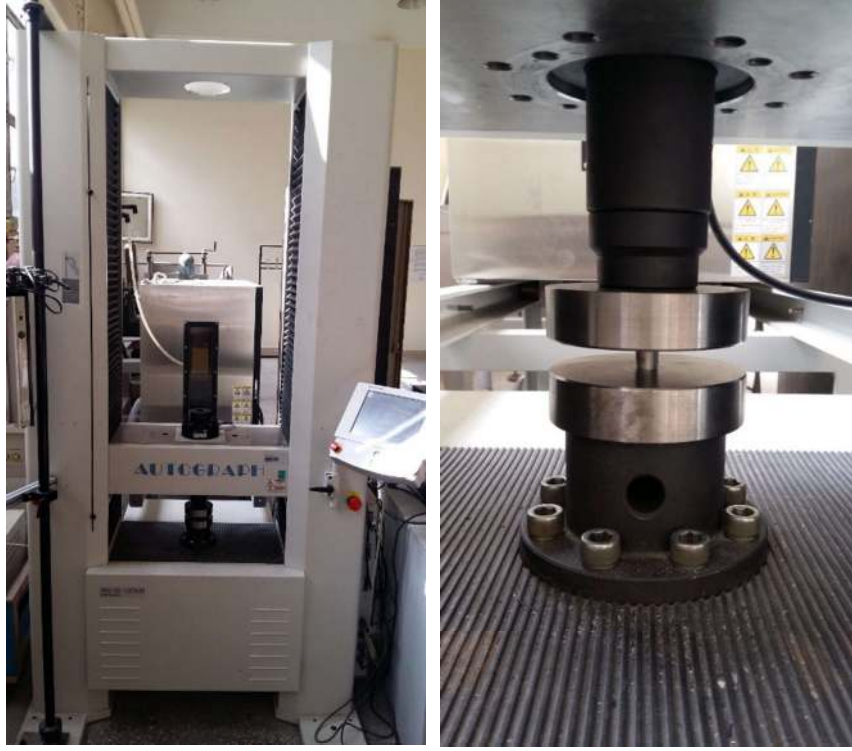
Şekil 4.8. Basma deneylerinin yapıldığı üniversal deney cihazı
