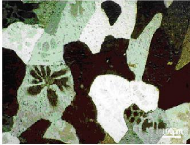
Şekil 1.7 Al-0,06%Ti alaşımında dendritlerin içerisinde yer alan koyu renkli ve titanyumca zengin bölgelere ait mikroyapı görüntüsü (Easton ve Stjohn, 2000)
