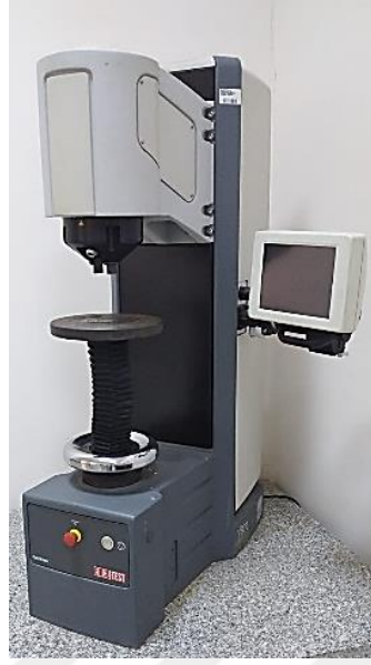
Şekil 3.17 Numunelerin sertlik ölçümlerinin yapıldığı cihaz
