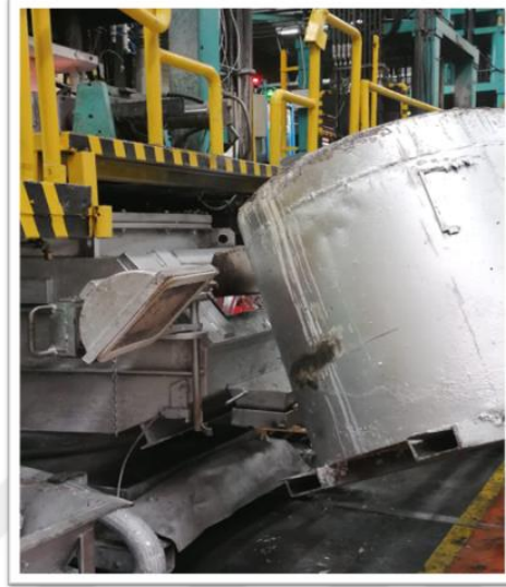
Şekil 3.13 Ergiyiğin alçak basınçlı döküm ünitesinin bekletme ocağına verilmesi
