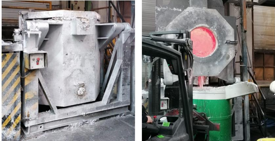
řekil 3.11 750 kg Al kapasiteli devirmeli tip elektrikli ergitme ocaėı
