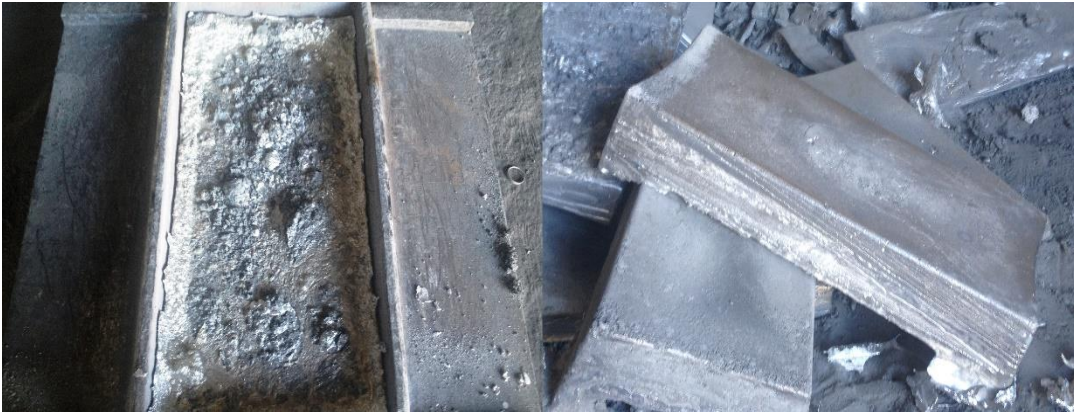
Şekil 2.14 : Curuf küveti altında kalan yüksek alüminyumlu (% 90 Al) yapı
