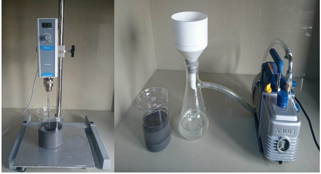
Şekil 3.3: Liç deneyi yapılışı ve vakumlu katı – sıvı ayrımı (süzme) deney seti
