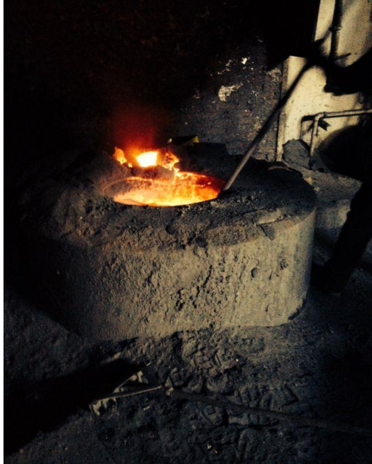
Şekil 2.16 : Alüminyum curufunu ergitmek için kullanılan yer ocağı
