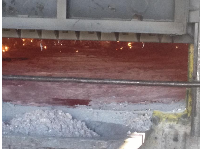
Şekil 2.11 : Curuf çekildikten sonra fırın görüntüsü
