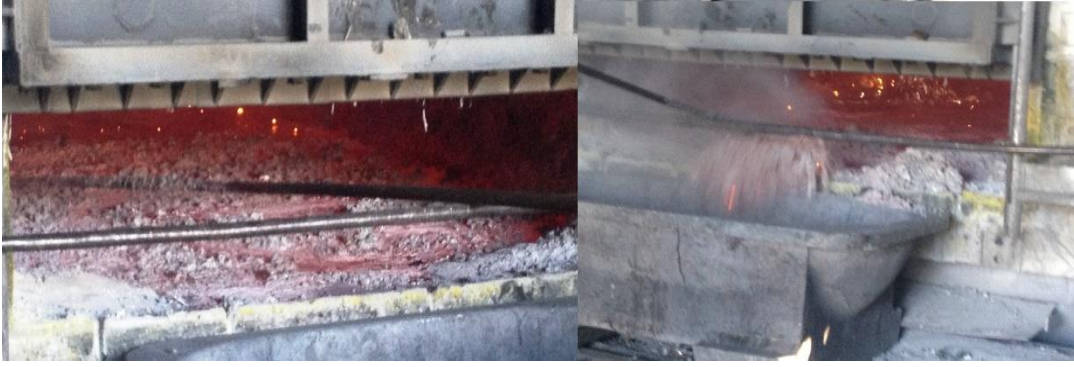
Şekil 2.9 : Curuf oluşurken ve çekilirken fırın görüntüsü
