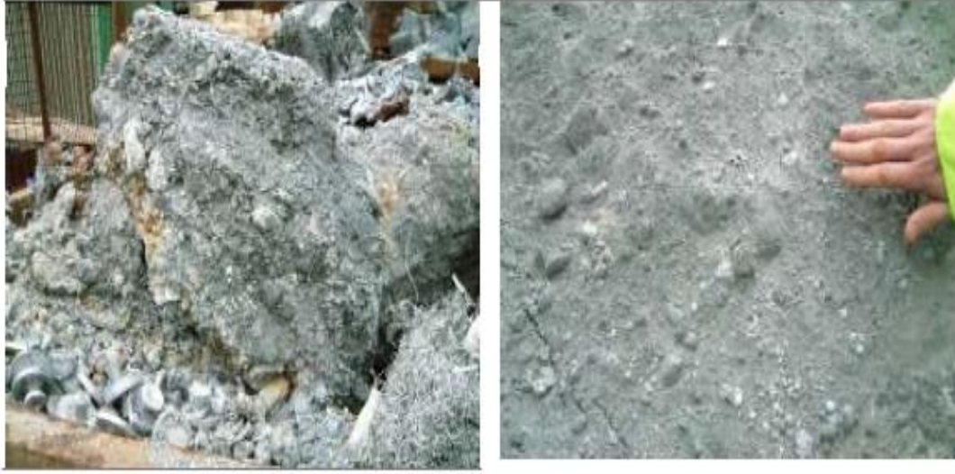
Şekil 2.6 : Alüminyum beyaz curufu (white dross) [20].
