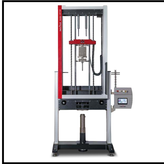
Şekil 2.15 Düşme kulesi test cihazı
