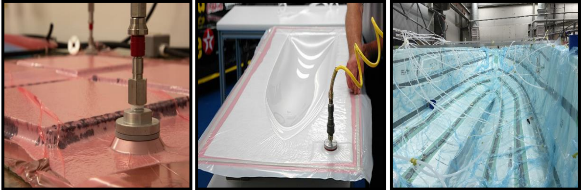
Şekil 2.6 Vakum torbalama(Vacuum Bagging ) yöntemi
