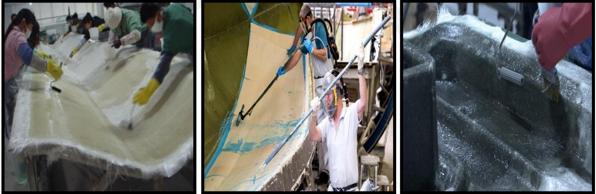
Şekil 2.4 Elle yatırma(Hand lay-up) yöntemi
