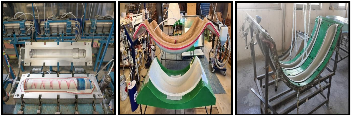
Şekil 2.8 Kalıba reçine enjeksiyonu (RTM) yöntemi
