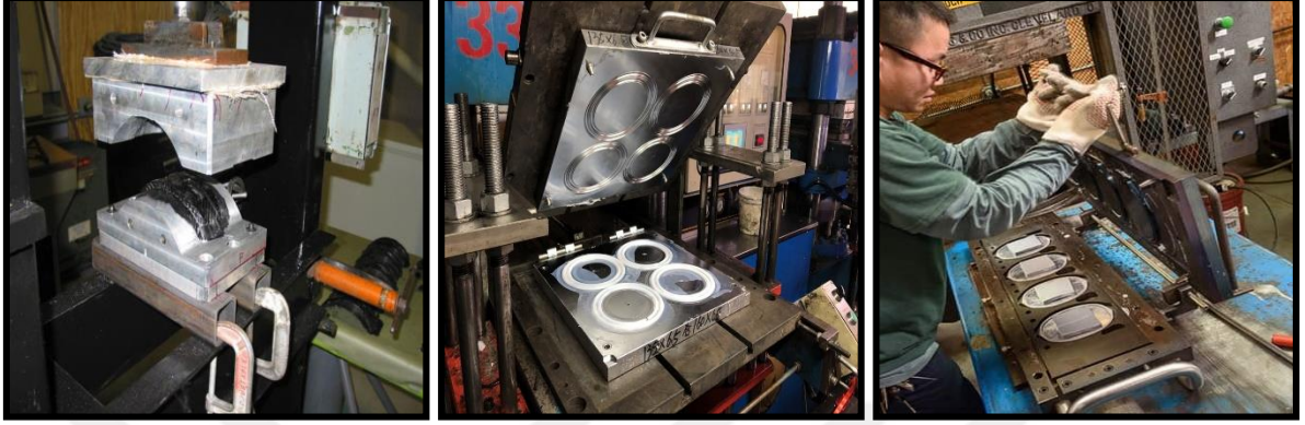
Şekil 2.7 Basınçla kalıplama(Compression molding) yöntemi
