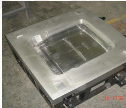
Şekil 3.3. Sünger üretiminde kullanılan alüminyum plastik kalıbı [54].
