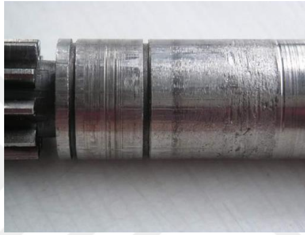
Şekil 3.5: Abrasyon (çizilme) aşınması (URL-1, 2024)
