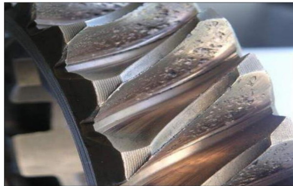
Şekil 3.11: Pitting çukurcuk oluşumu (URL-1, 2024)
