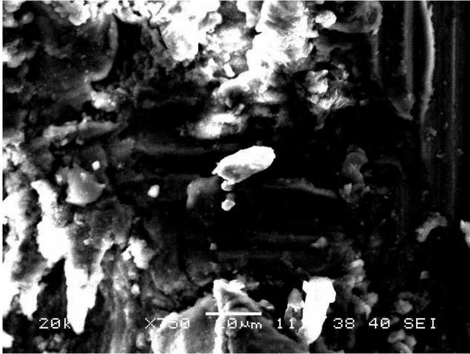
Resim 6.42. İşlem görmemiş Ç numunesinin çizik merkezi SEM fotoğrafı
