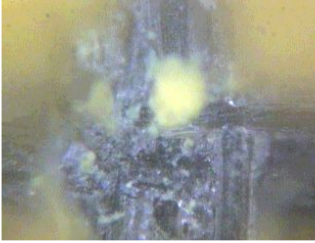
Resim 6.38. Kromatlanmış K numunesinin 14.gün yüzey mikrofotografı
