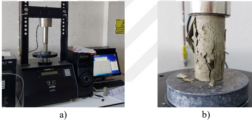
Şekil 5.8: a) Serbest basınç deneyi b) deney sonucu kırılan bir numune örneği
