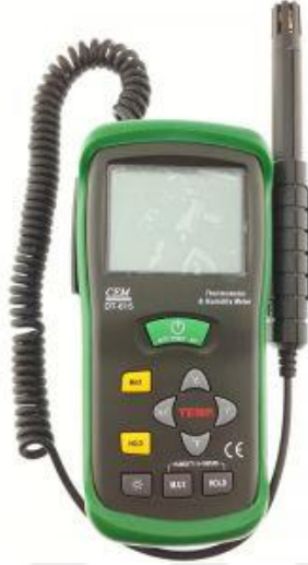
Şekil 3.10. Nem ölçümleri için kullanılan CEM dt-615 hygrometre cihazı.
