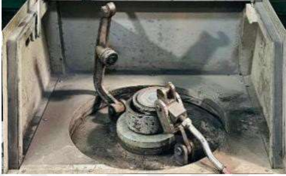
Şekil 18. Halkalı öğütücü sistemi
