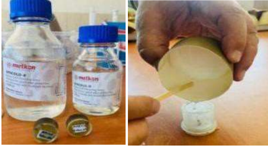
Şekil 25. Epoksi reçine (Metkon Epocold-R) ile kalıplanmış numunenin hazırlanması
