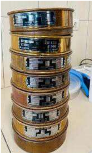
Şekil 15. Laboratuvar ortamında gerçekleştirilen yaş elek analizi süreci ve farklı boyut fraksiyonlarına ait numune görselleri
