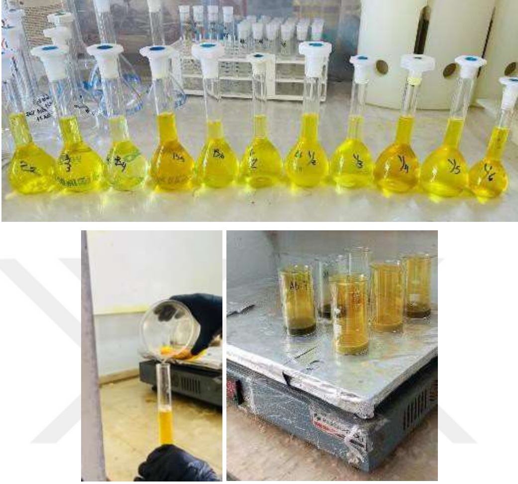
Şekil 19. Kral suyu ile çözündürülmüş katı numunelerin analiz öncesi çözelti hâli
