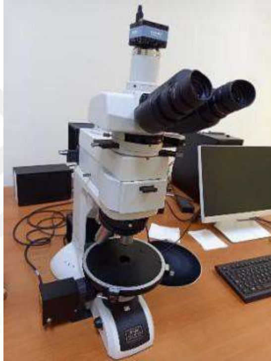
Şekil 27. Polarizan mikroskop inceleme ve görüntüleme sistemleri
