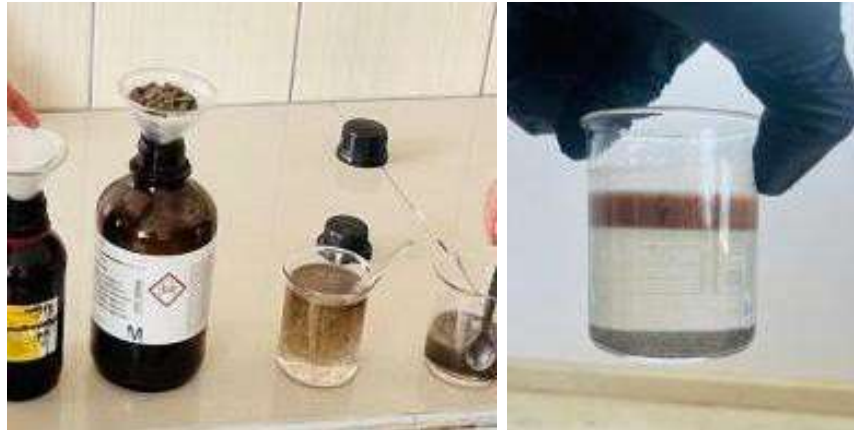
Şekil 23. Yüzdürme –Batırma test ünitesi
