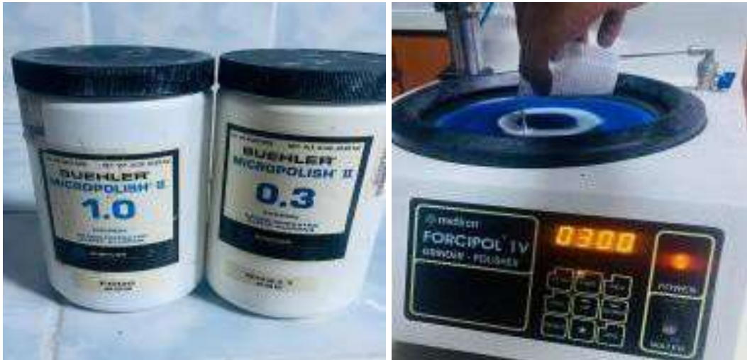
Şekil 26. Metkon Forcipol 1V cihazında numunenin P300–P1200 arası zımparalanması
