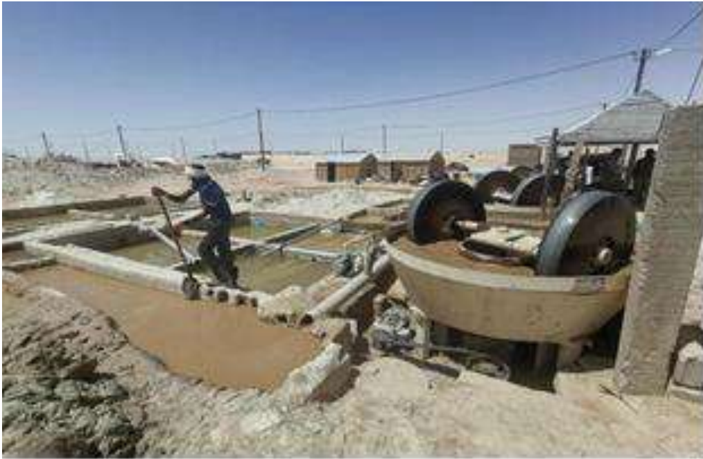
Şekil 9. Chami'deki valsli değirmenlerle cevherin yaş öğütülmesi ve işleme uygulamaları
